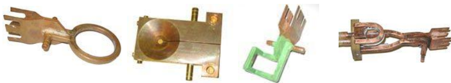
Рис. 4.2. Примеры индукторов для конкретных технологий, с учетом особенностей нагрева, например, пайка твердосплавного инструмента или плавка во взвешенном состоянии (ливнотирующая плавка)
