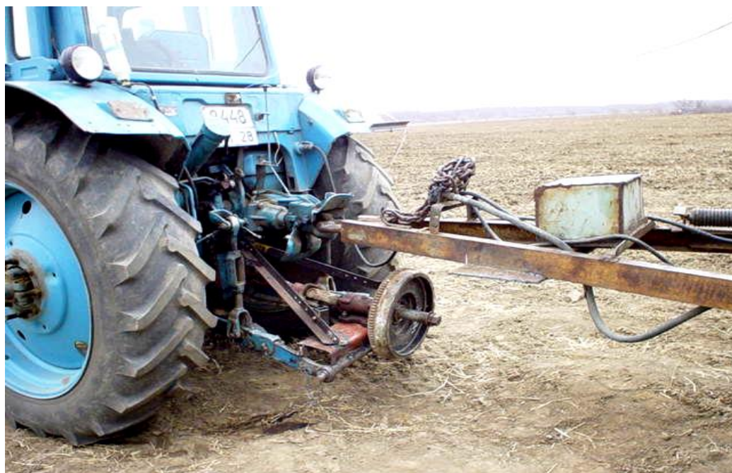
Рис 3.5. Трактор МТЗ-82 с дополнительно установленным маховиком
