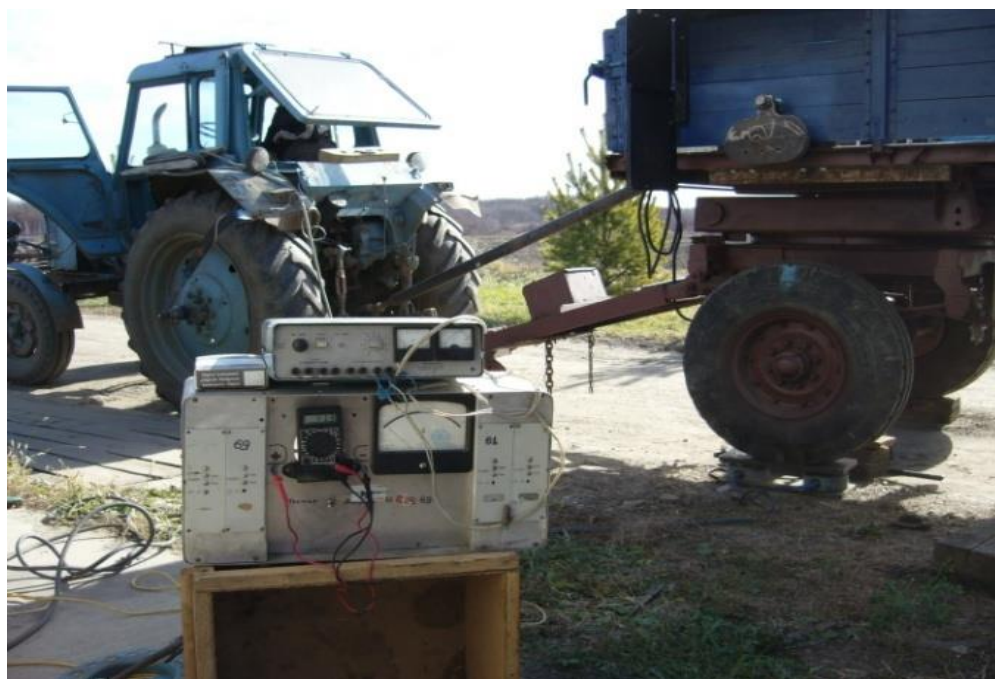
Рис. 3.15. Соединение тензорезисторов с преобразователем сигнала
