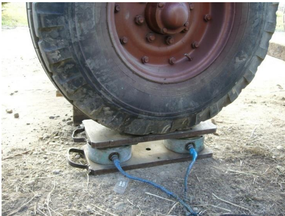
Рис. 3.14. Датчики давления, установленные под колесо прицепа
