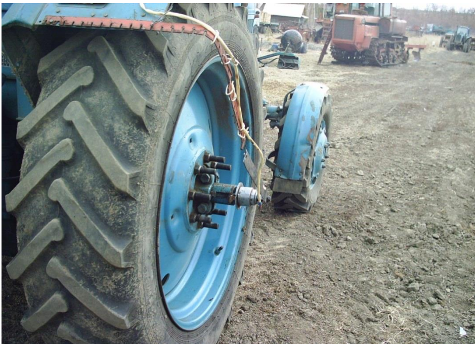
Рис. 3.13. Измерение числа оборотов ведущих колес
