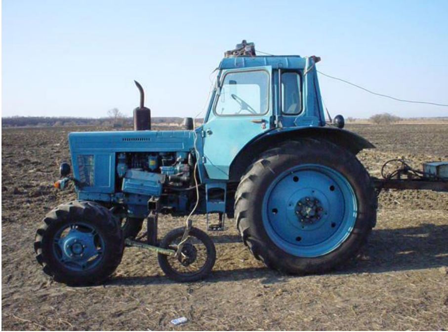
Рис. 3.12. Пятое колесо, смонтированное на тракторе
