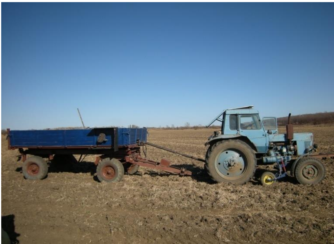
Рис 3.7. Прицеп 2ПТС-4 с дополнительно установленными дисбалансами
