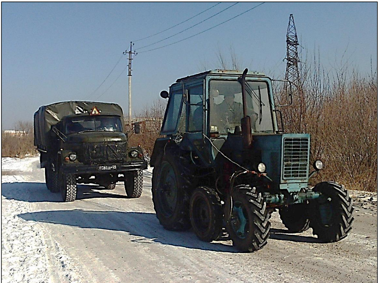
Рис.3.9. Фрагмент тяговых испытаний на заснеженной дороге
