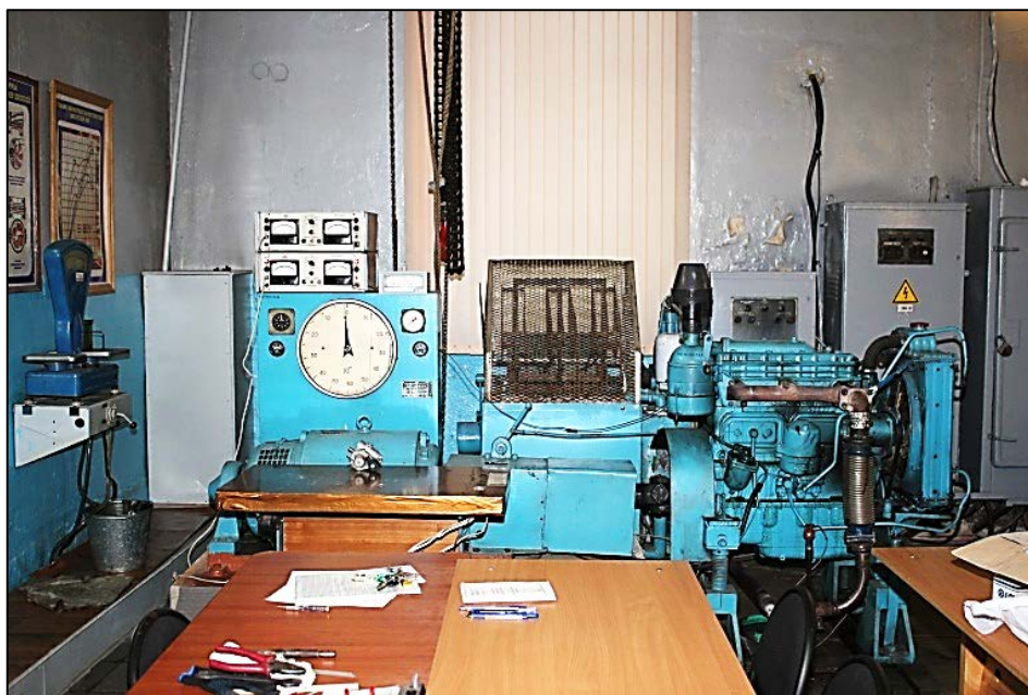
Рис.1.Тормозной стенд с Двигателем Д-50
