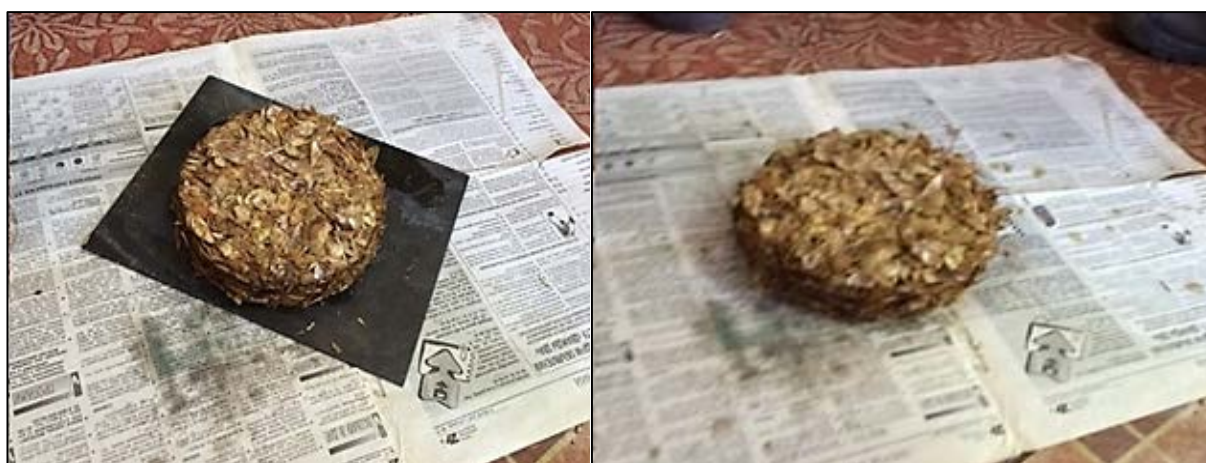
Рис. 5. Внешний вид соевой половы (стебельно-бобовая часть) после прессования при влажности 18,7 % и усилия 3,5 тс ( P_{\text{уд}} = 20,08 \text{ кгс/см}^2 )
