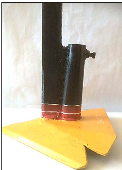
Рис.1. Экспериментальный рабочий орган сеялки СП-4,6. Лаповый сошник для посева сои полосой 18...20 см
