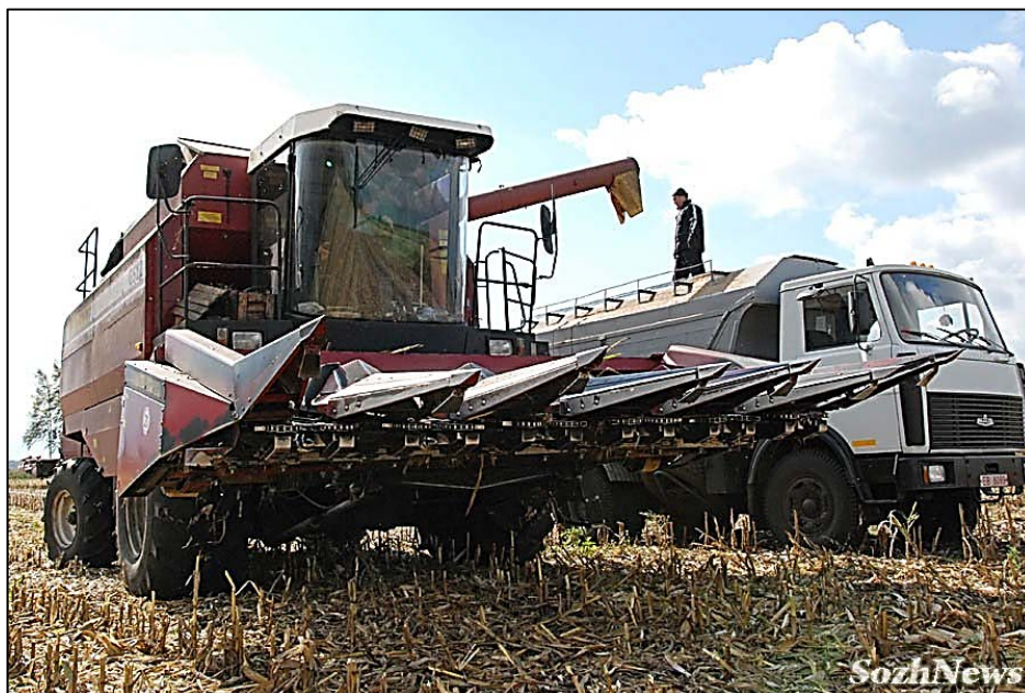
Рис.3. Жатка для уборки кукурузы на зерно КОК-6-3-01
