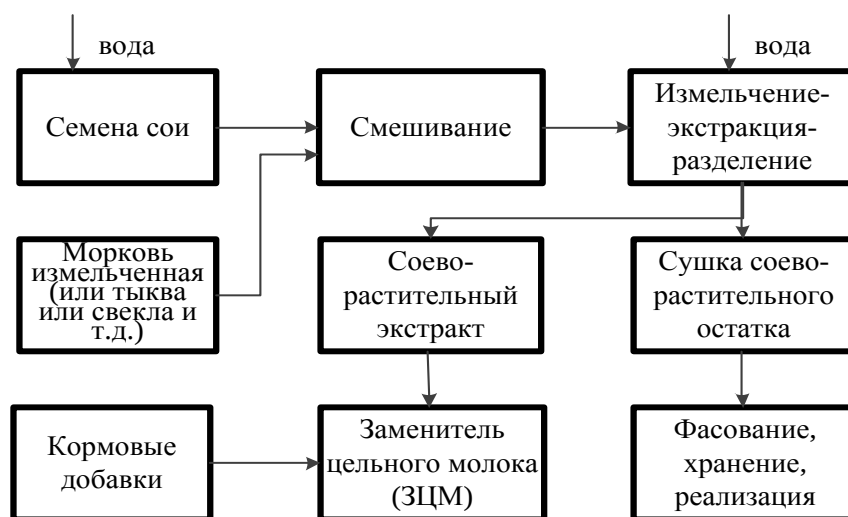
Рис. 2. Принципиальная технологическая схема приготовления соево-морковных продуктов
