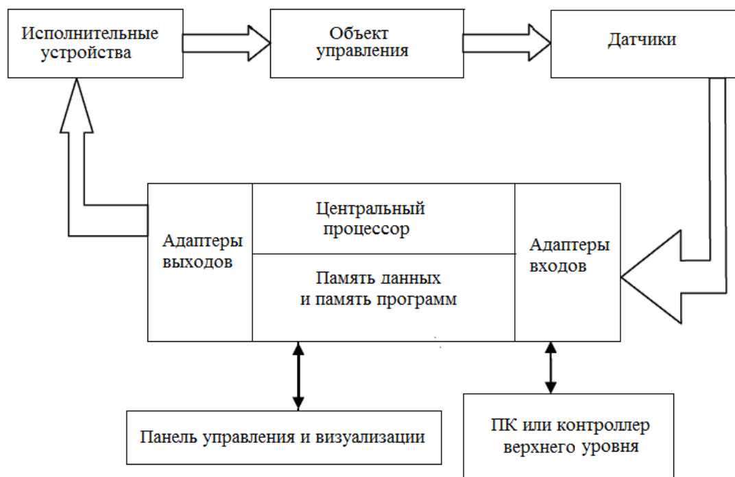
Рис. 1. Структура системы автоматизированного управления комплексом по приготовлению сбалансированных комбикормов
