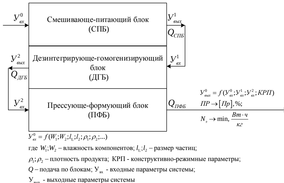
Рис.1. Структурно-функциональная схема пресса для получения гранулированно-брикетированных смесей на основе корннеплодно-зерновых композиций
