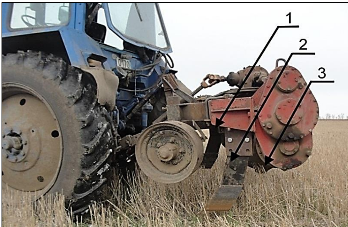
Рис.1. Экспериментальный образец модернизированного ротормного плуга: 1, 2 – почвоуглубители; 3 – ротор.
