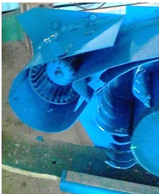
Рис. 2. Установка дополнительного вентилятора
