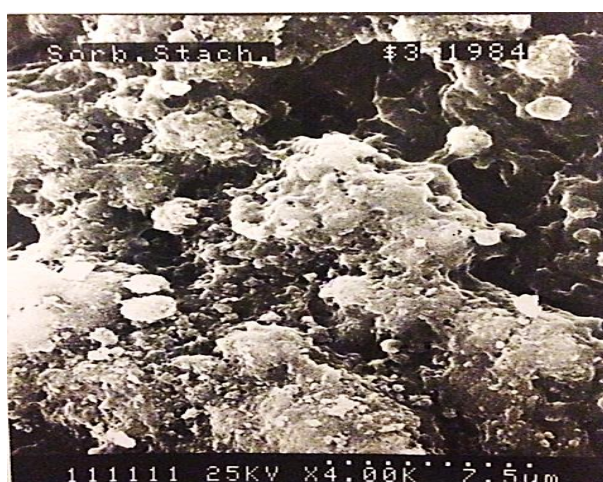
Рис.1. Скан-электронограмма внешней поверхности углеродминерального сорбента марки СКН-4 с адсорбированными на ней колониями стафилококка (ув.4000) Количество-98245 колоний
