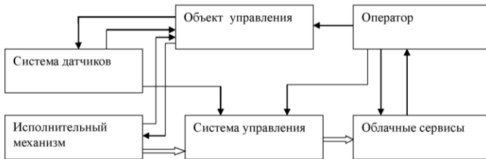
Рис. Принципиальная схема использования облачных сервисов
