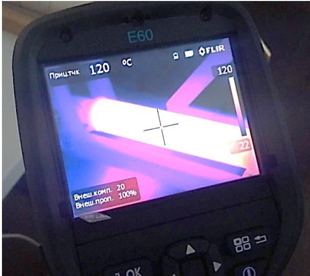
Рис.2. Фрагмент определения температуры нагрева экспериментальной установки
