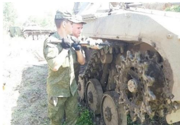
Рис. 3. Демонтаж и монтаж гусеницы БМП-2
