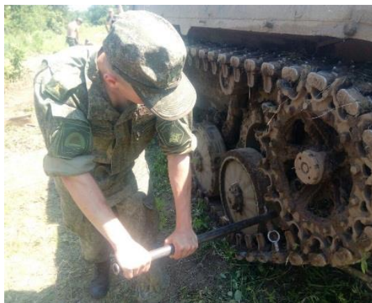
Рис.2. Откручивание болтов крепления скобы гусеницы
