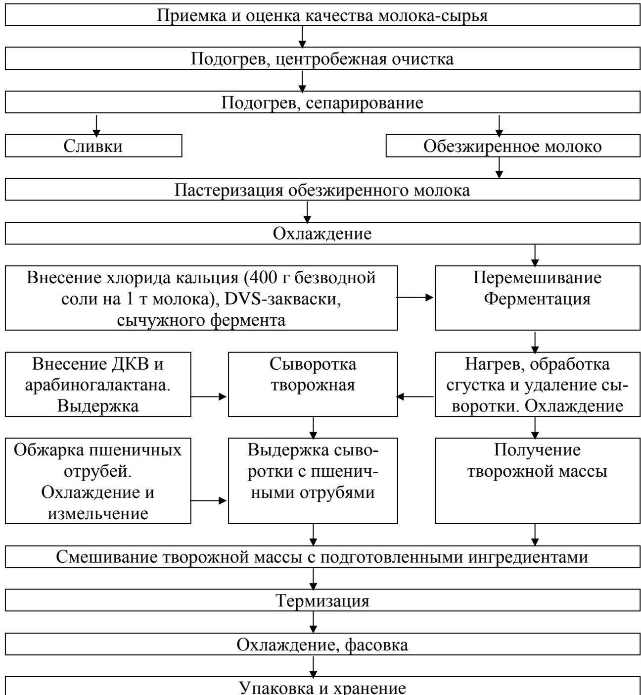
Рис. 21. Технологическая схема производства творожного продукта «Стимул»
