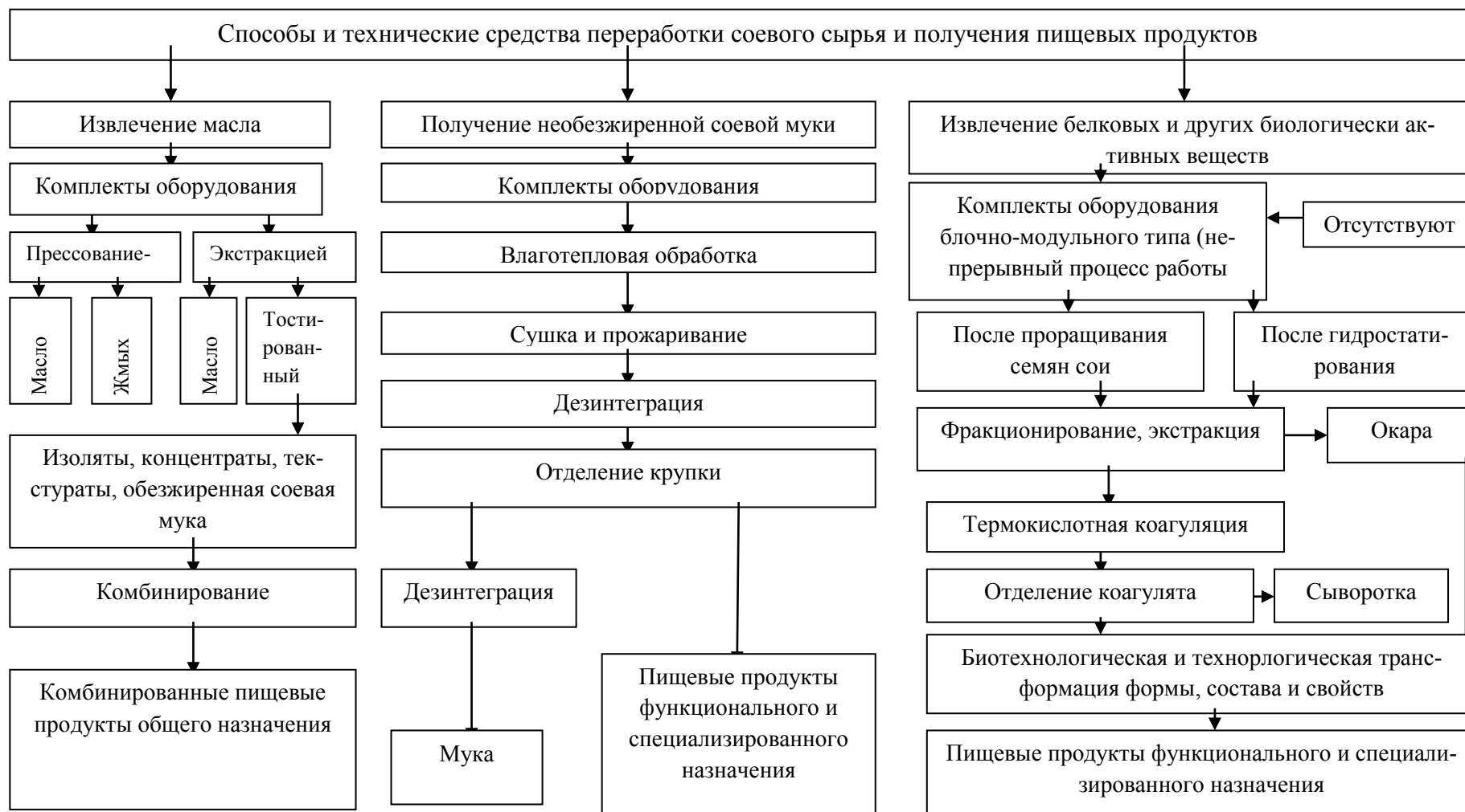
Рис. 1.1. Схема к анализу современного состояния переработки семян сои на пищевые цели
