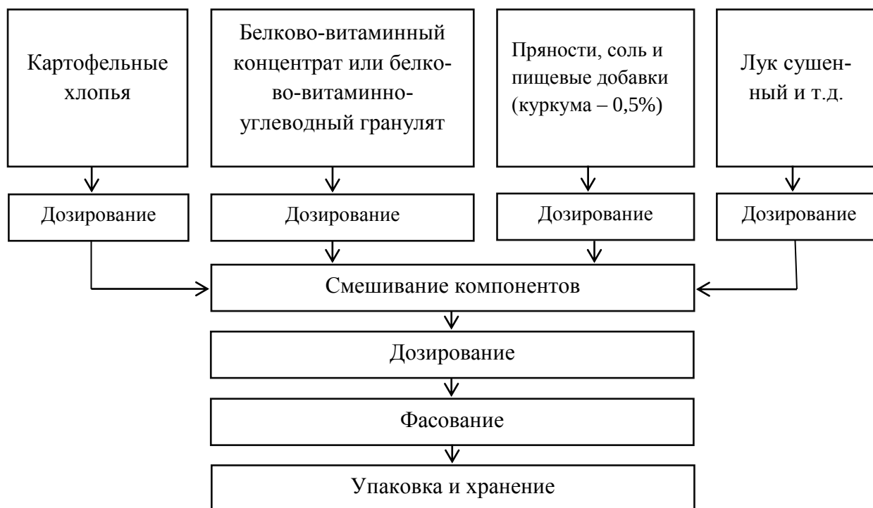
Рис. 8.4. Технологическая схема производства пищевых концентратов вторых обеденных блюд
