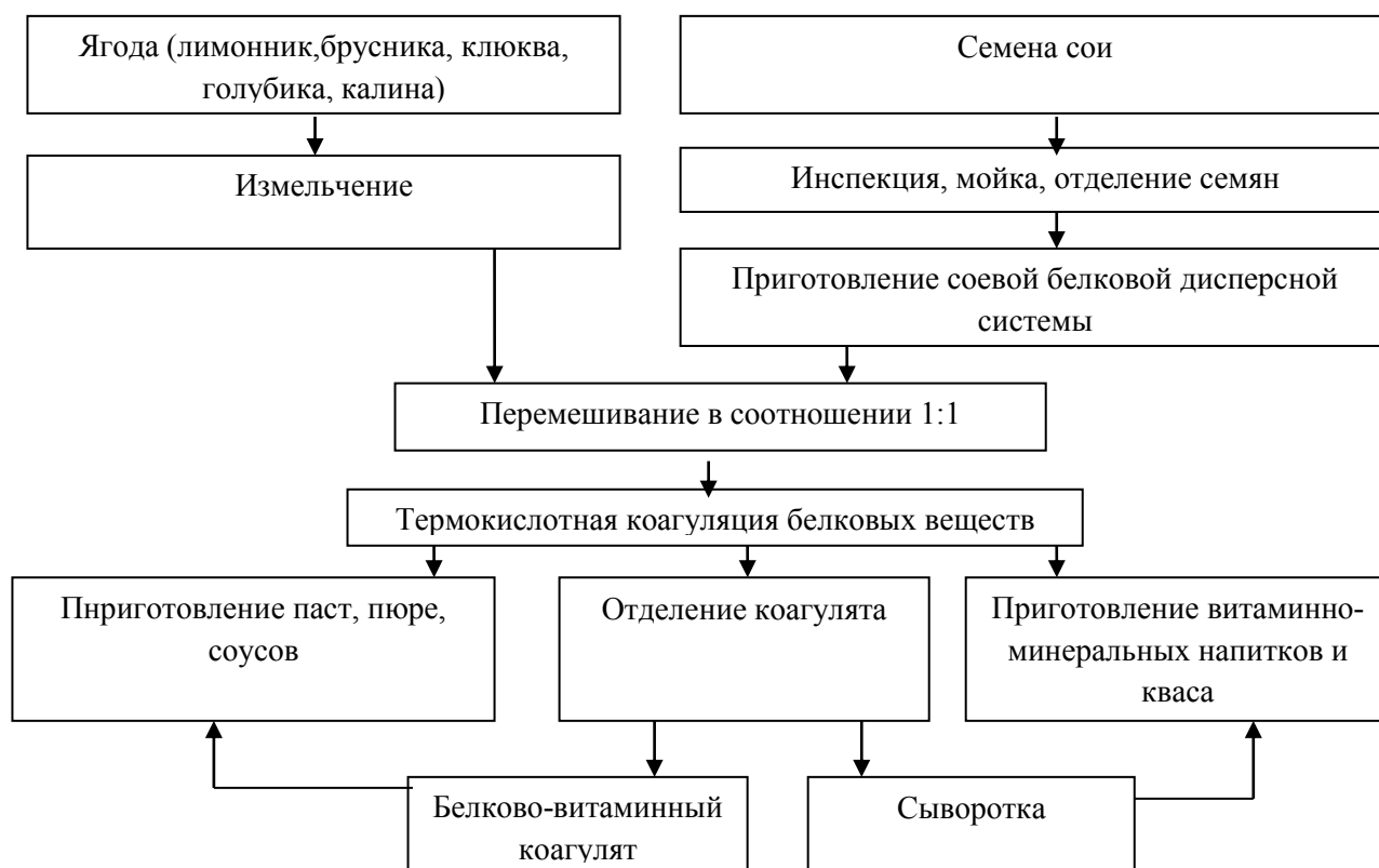
Рис. 4.14. Технологическая схема получения белково-витаминных продуктов
