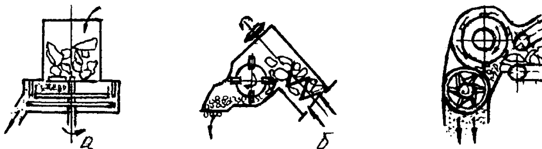
Рис. 1.2. Типы аппаратов для измельчения корнеплодов: а - рубящие ножевые; б - ударные; в - комбинированные: рубящие и режущие
