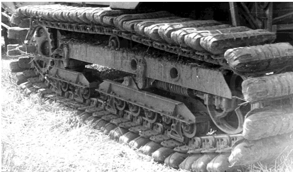
Рис. 5.1. Цепной пневмогусеничный движитель с пневмотраками модели «Л-5» с размерами 650x155x115 мм
