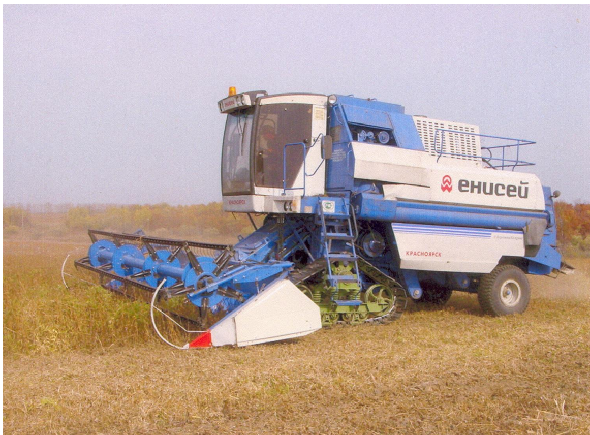
Рис. 6.9 Комбайн «Енисей КЗС-958» с треугольным металлогусеничным движителем на уборке сои
