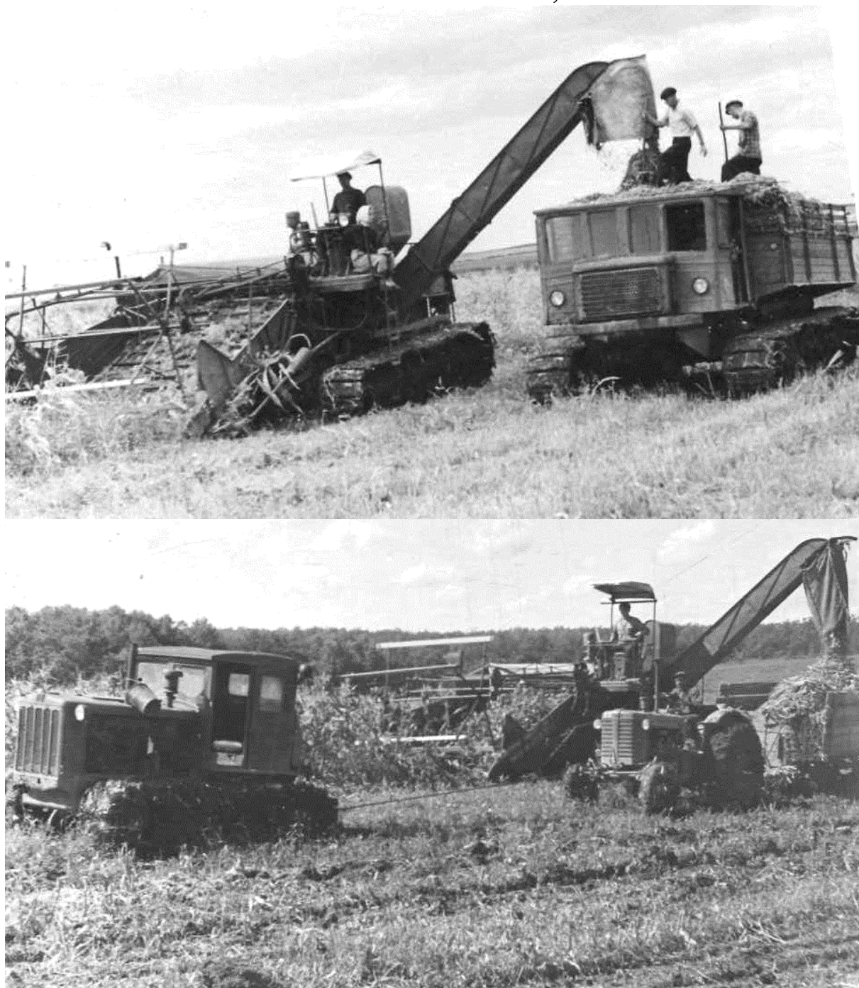
Рис. 4.13. Комбайн СКГС - 2,6. Уборка кукурузы на силос
