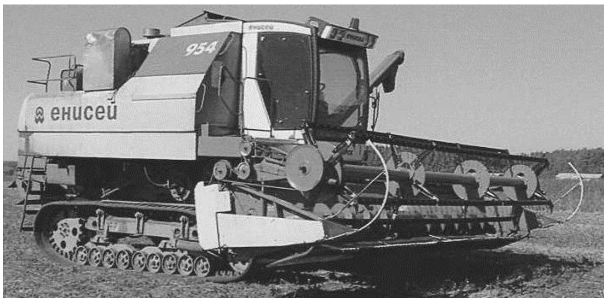
Рис. 4.11. Общий вид комбайна «ЕНИСЕЙ КЗС 954» на резиноармированных гусеницах.
