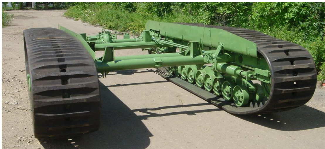
Рис. 5.3. Гусеничная тележка с резиноармированными гусеницами ТГР-3
