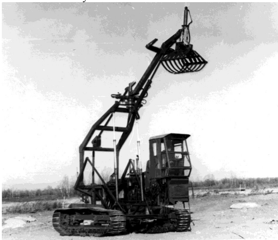
Рис. 4.50. Стогометатель с поворотной стрелой и грейфером на гусеничном шасси ГШ-75
