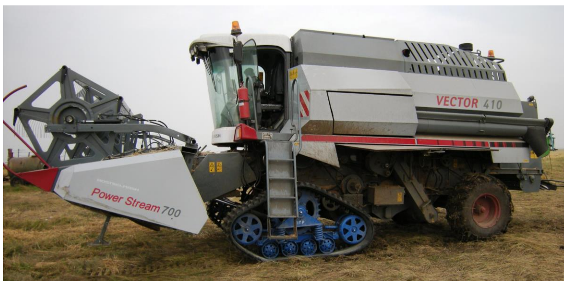
Рис. 6.5. Общий вид комбайна самоходного зерноуборочного «Вектор 410», переоборудованного на шасси полугусеничное сменное на резиноармированных гусеницах
