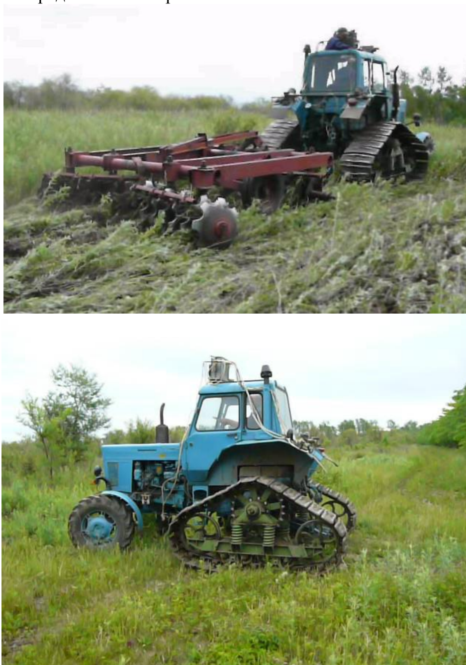
Рис. 6.7 Рабочие фрагменты испытаний трактора МТЗ-80 с треугольным металлогусеничным движителем
