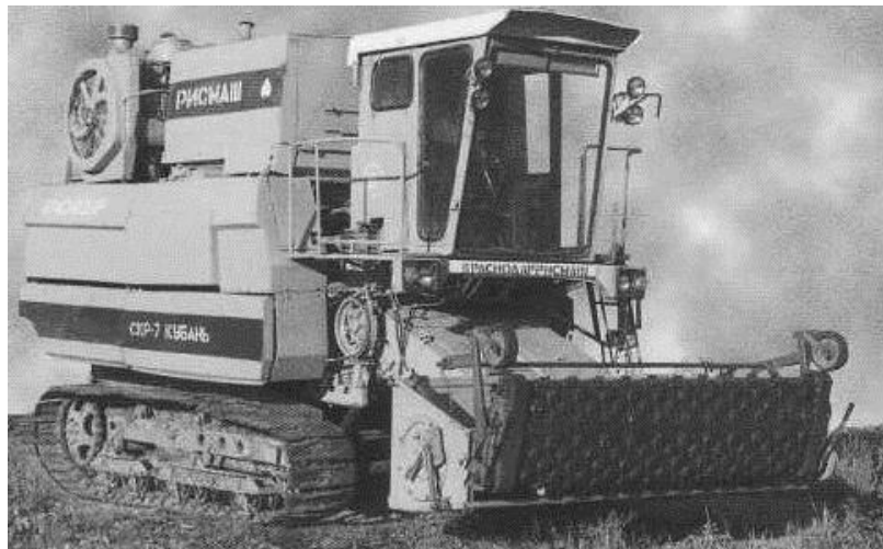
Рис.4.8. Самоходный рисозерноуборочный комбайн на цельногусеничном ходу СКР-7 «КУБАНЬ»
