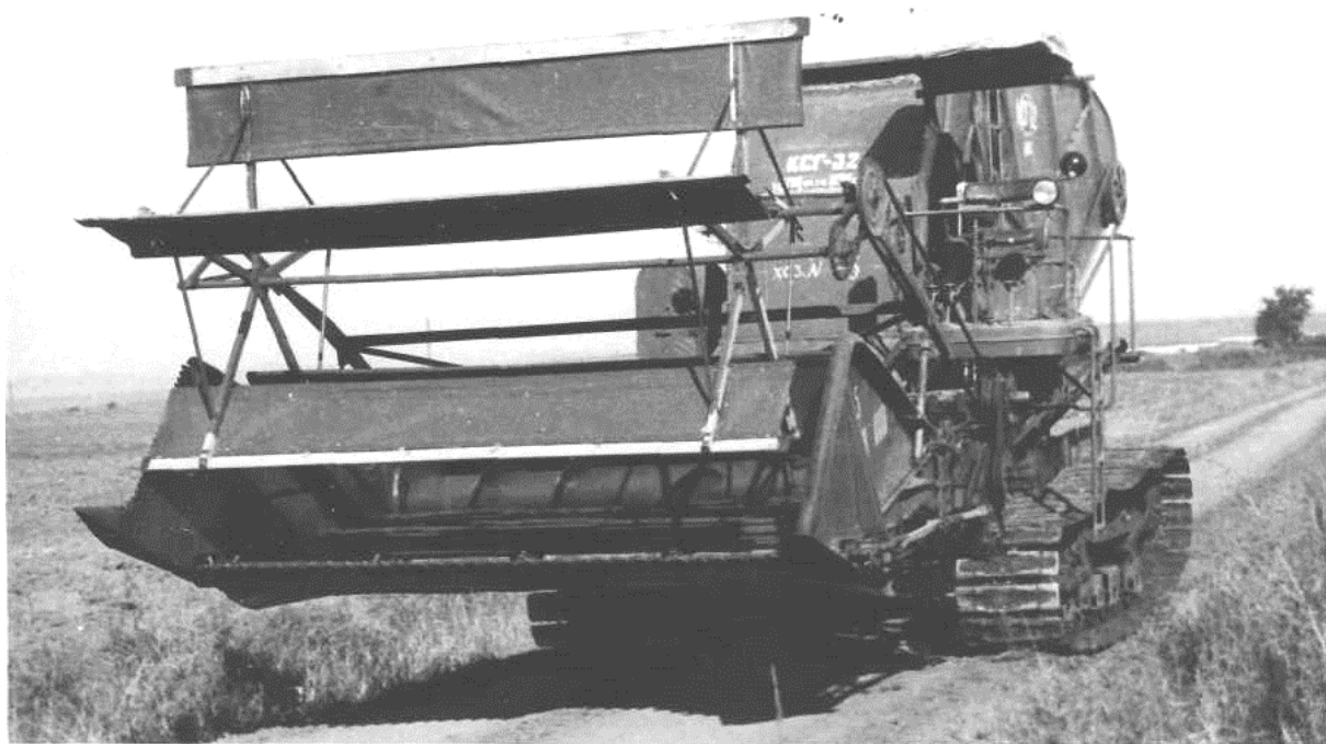
Рис. 4.15. Силосоуборочный комбайн КСГ-3,2 (вид спереди)
