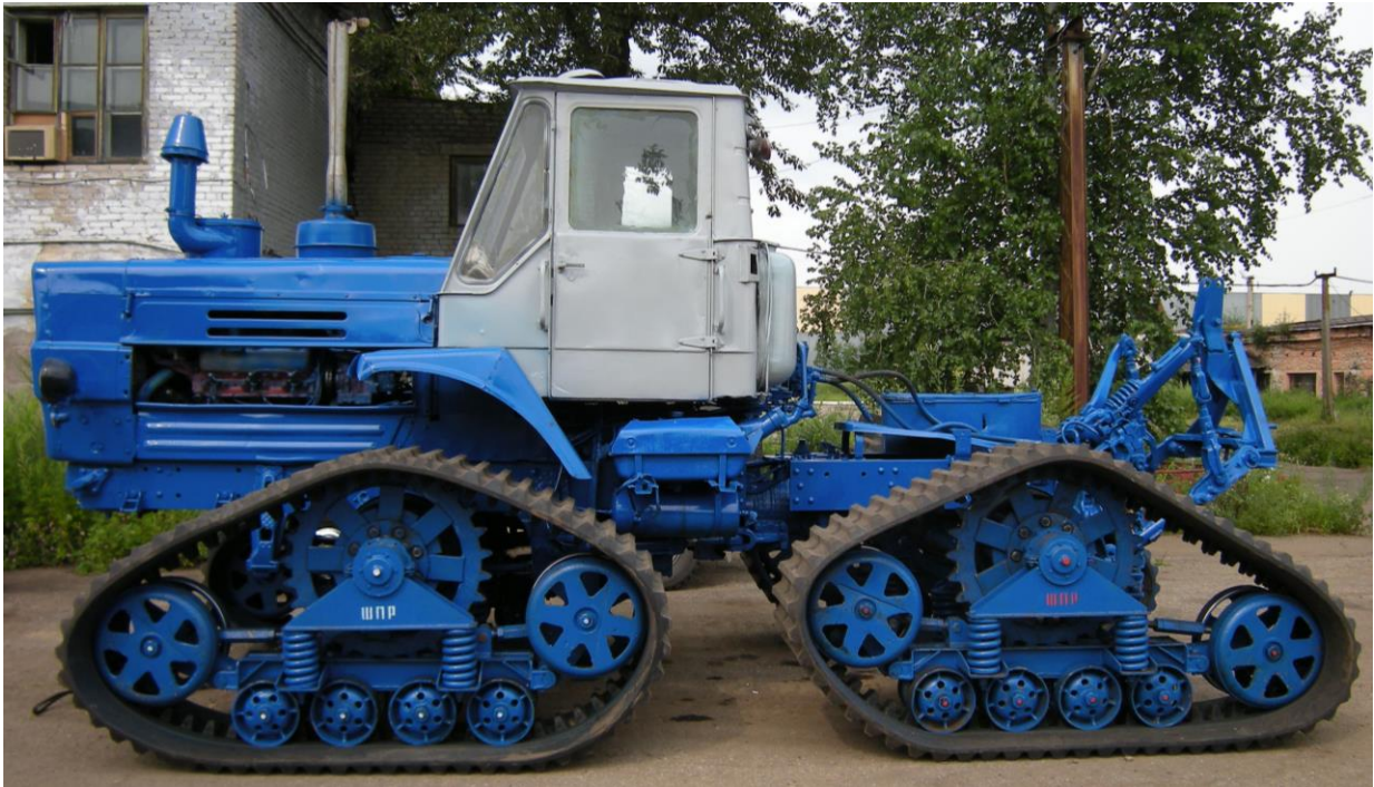
Рис. 6.6 Общий вид трактора Т-150К, переоборудованного на шасси полугусеничное сменное на резиноармированных гусеницах.
