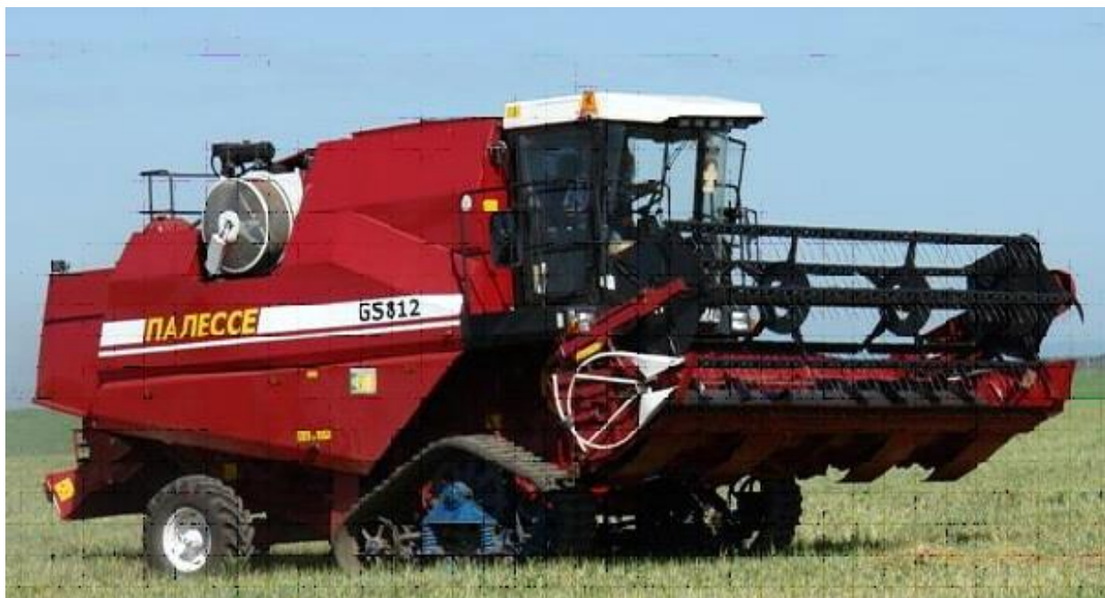
Рис. 6.4. Общий вид комбайна самоходного зерноуборочного КЗС-812«Палессе», переоборудованного на шасси полугусеничное на резиноармированных гусеницах
