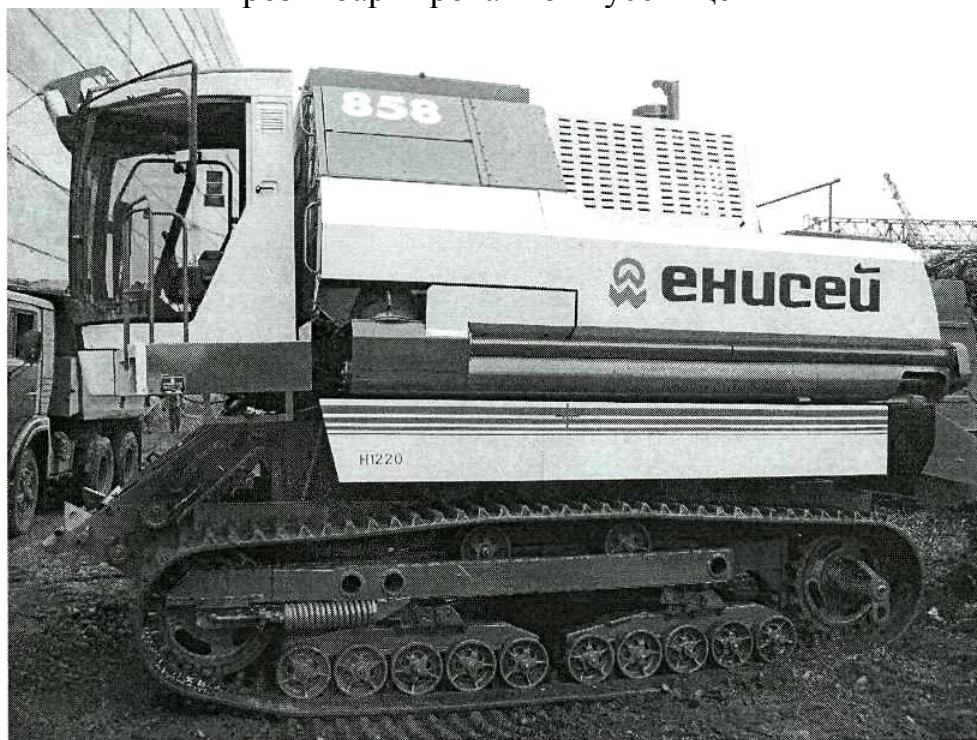
Рис. 4.12. Общий вид комбайна «ЕНИСЕЙ - 858» на резиноармированных гусеницах.
