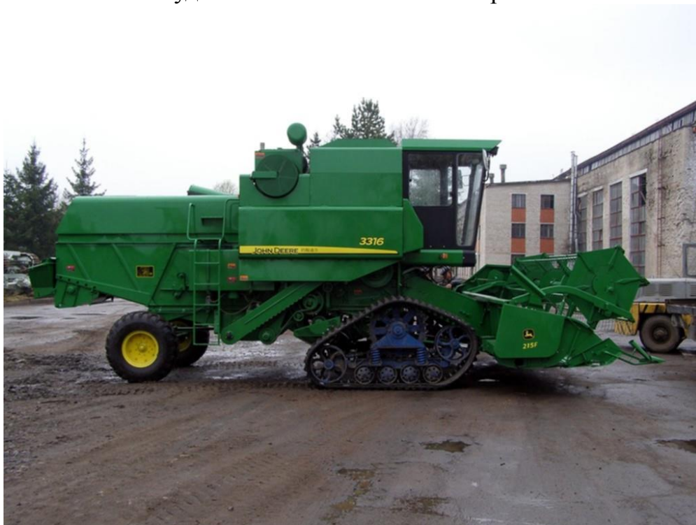
Рис. 6.3 Общий вид комбайна «Джон Дир» с удлинённой наклонной камерой, модель 3316, переоборудованного на шасси полугусеничное сменное на резиноармированных гусеницах
