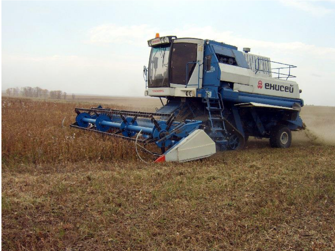
Рис. 6.8 Комбайн «Енисей КЗС-958» с треугольным гусеничным движителем с резиноармированными гусеницами на уборке сои
