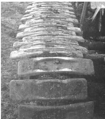
Гусеничная цепь со смещенными опорными плитами
