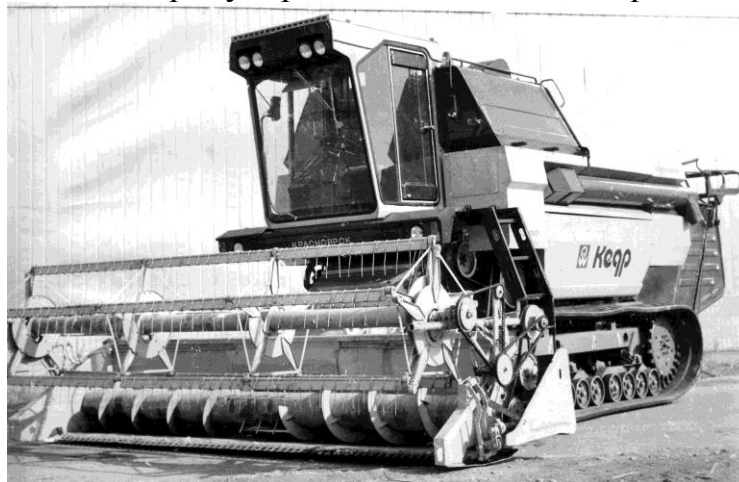
Рис.4.9. Комбайн рисозерноуборочный «Кедр - 1200Р»
