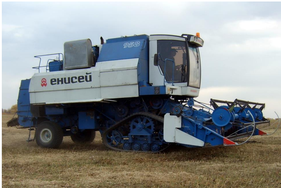
Рис.6.2 Общий вид комбайна «Енисей КЗС-958», переоборудованного на шасси полугусеничное сменное на резиноармированных гусеницах
