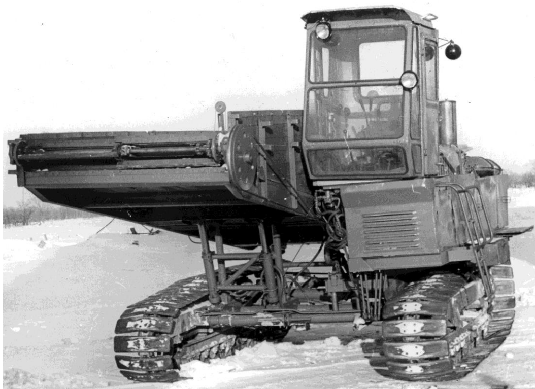
Рис. 4.53. Кузов-перегрузчик с транспортером (вид спереди)
