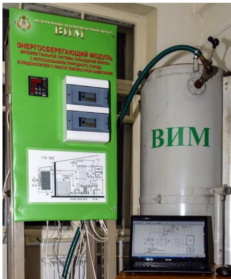
Рис. 1. Энергосберегающий модуль для охлаждения молока на фермах с использованием природного холода и экологически безопасных хладагентов с низкой температурой замерзания
