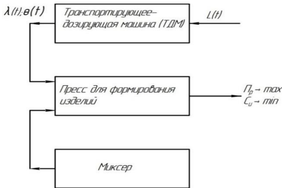
Рис. 2. Структурно-функциональная схема подсистемы производства строительных изделий сельскохозяйственного назначения
