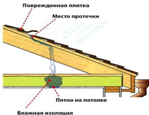
Рис. 1. Первопричина исправления нарушения кровли
