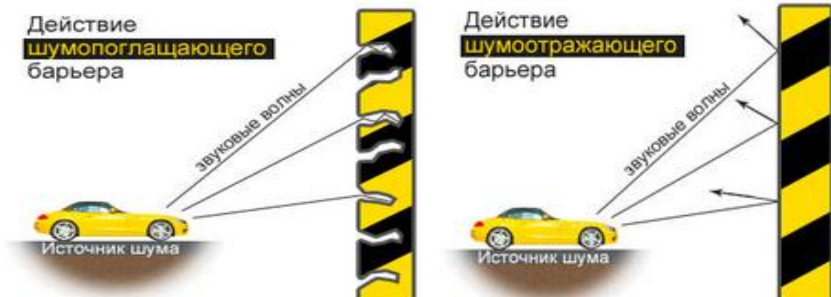
Рис. 2. Шумопоглощающий и шумоотражающий экраны
