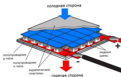
Рисунок 1 – Термоэлектрический модуль Пельтье
