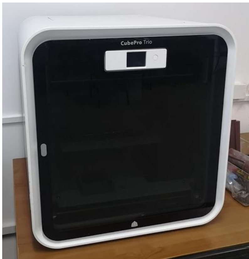
Рисунок 2 – FDM – принтер закрытого типа с удаленным способом подачи
