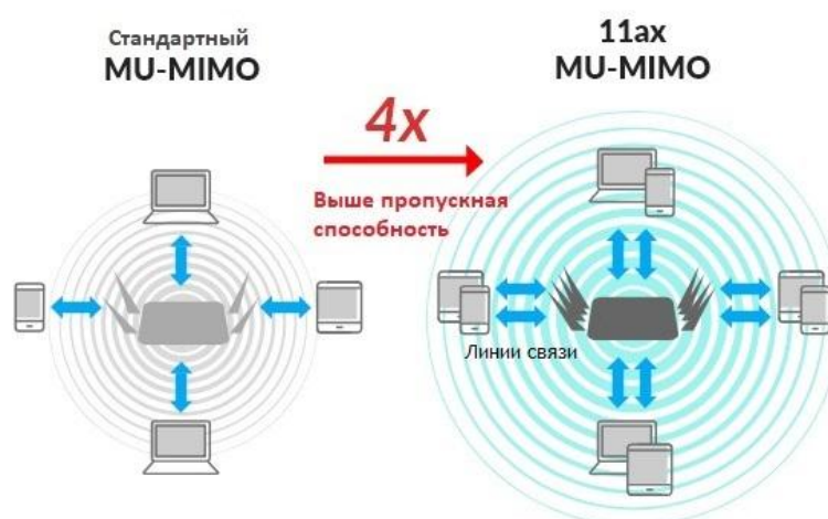
Рисунок 1 – Сравнение стандартного режима MIMO и MU-MIMO в 802.11ax
