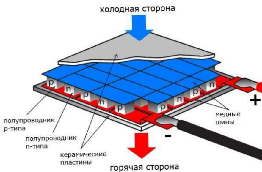
Рис. 1. Конструкция элемента Пельтье
