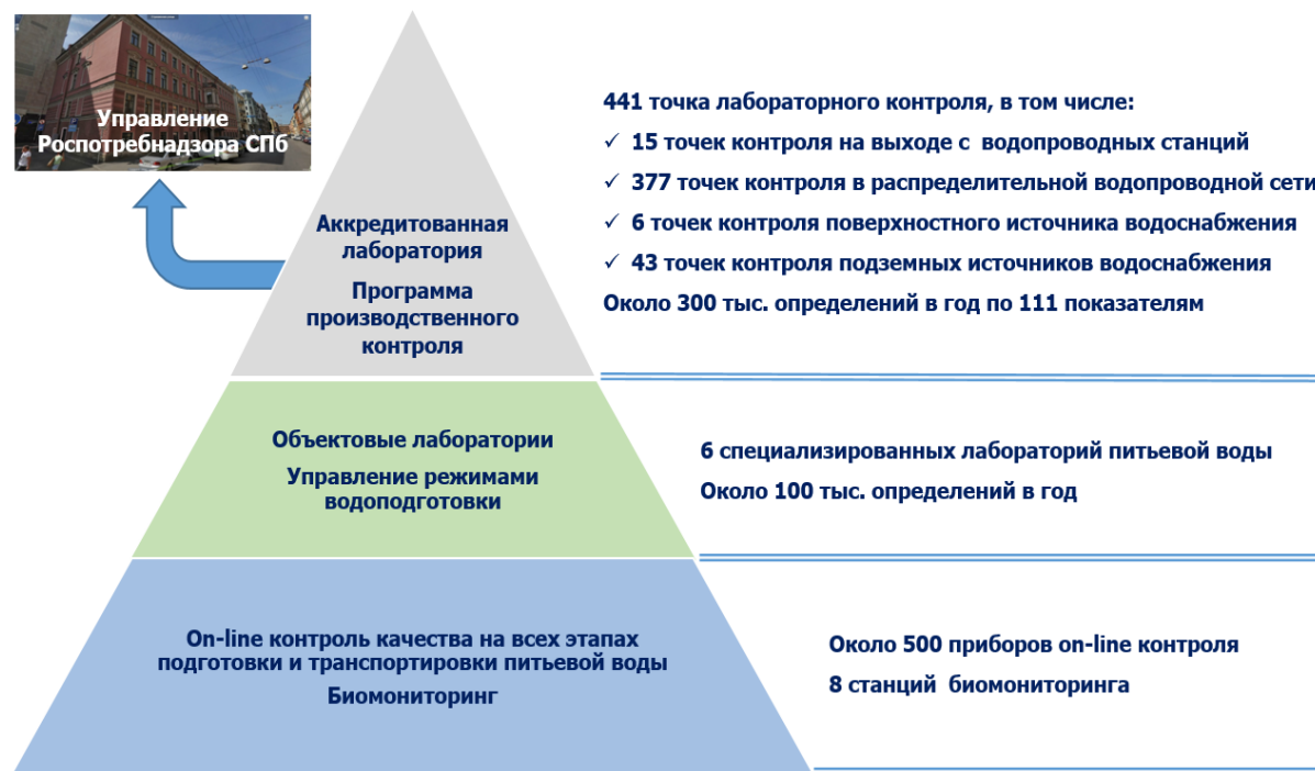
Рис. 1. Система контроля качества воды в Санкт-Петербурге
