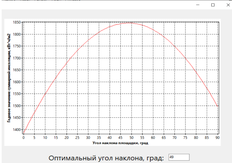
Рис. 4. Результаты расчёта оптимального угла наклона для местности в районе Зейской ГЭС
