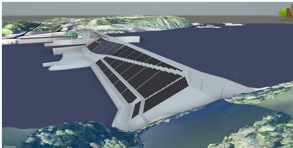
Рис. 2. Модель проектируемой СЭС на Нижне-Бурейской ГЭС
