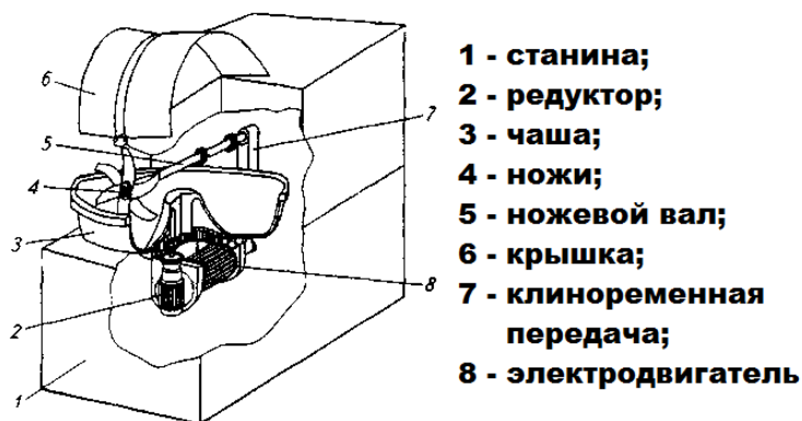
Рис. 2. Механизм куттера
