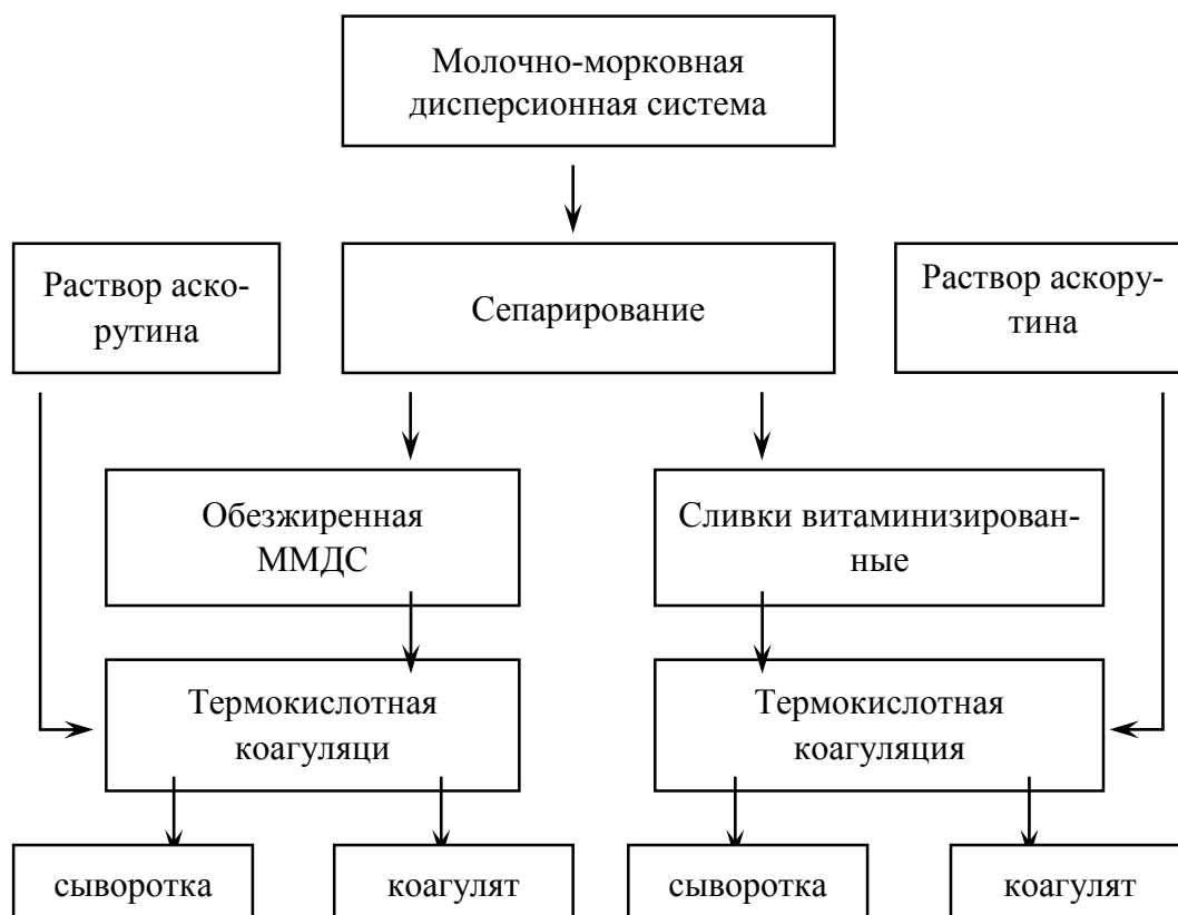
Рис.2. Принципиальная схема получения молочно- и сливочно-морковных коагулятов
