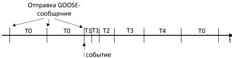
Рис. 3. Время передачи GOOSE-сообщения
