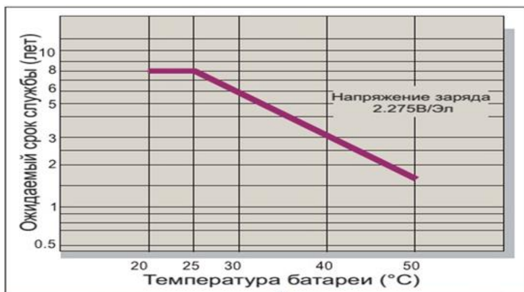
Рис. 1. График службы аккумуляторной батареи от температуры окружающей среды
