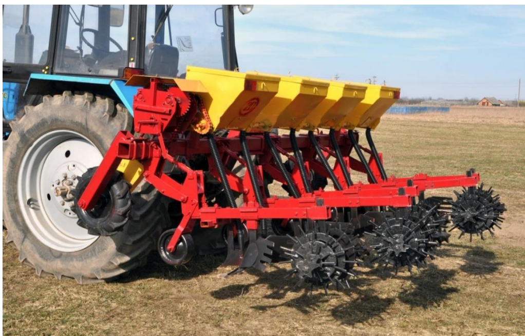
Рис. 2. Культиватор окучник КОН-2,8
