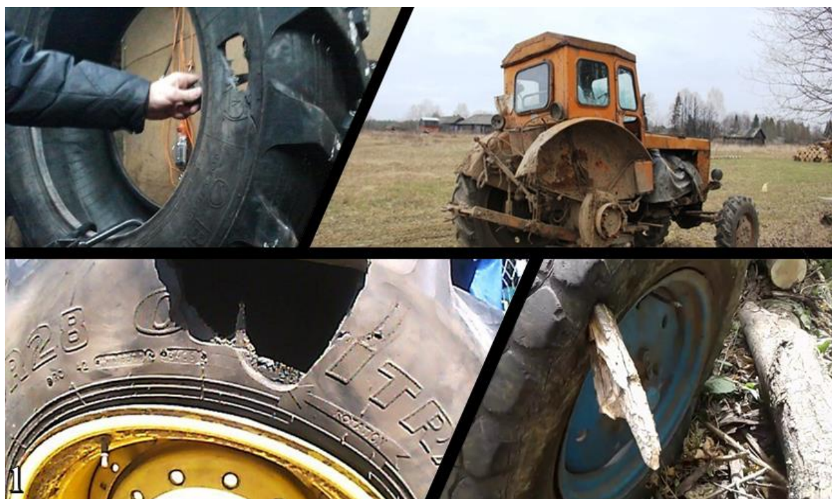
Рис. 1. Виды повреждений колёсного движителя в движении
