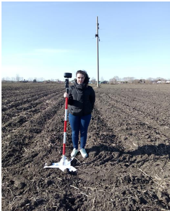
Рис. 6. Привязка при помощи опознавательных знаков
