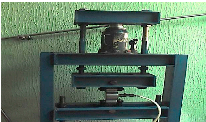
Рисунок 3.21 – Проведение тарирования тензометрического звена
