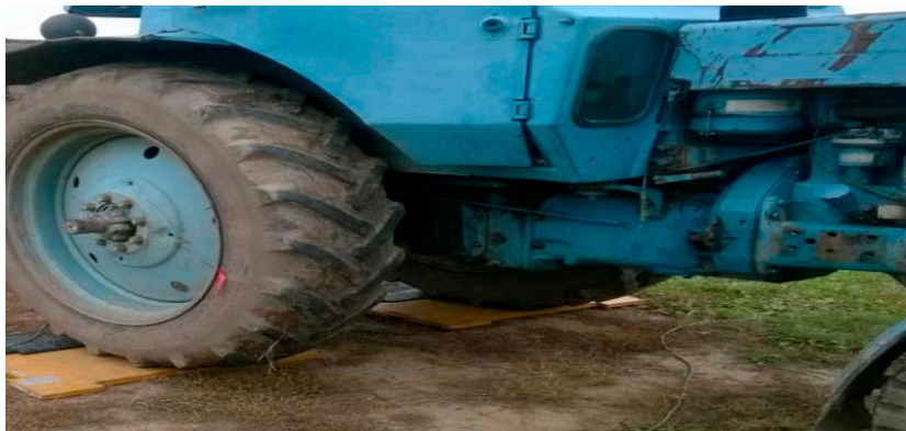
Рисунок 3.20 – Фрагмент измерения веса, приходящегося на колеса трактора
