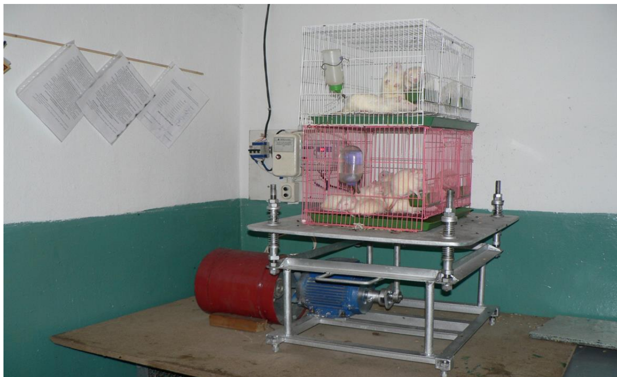
Рисунок 2.1 – Установка, имитирующая вибрационные колебания железнодорожного вагона с экспериментальными крысами в клетках
