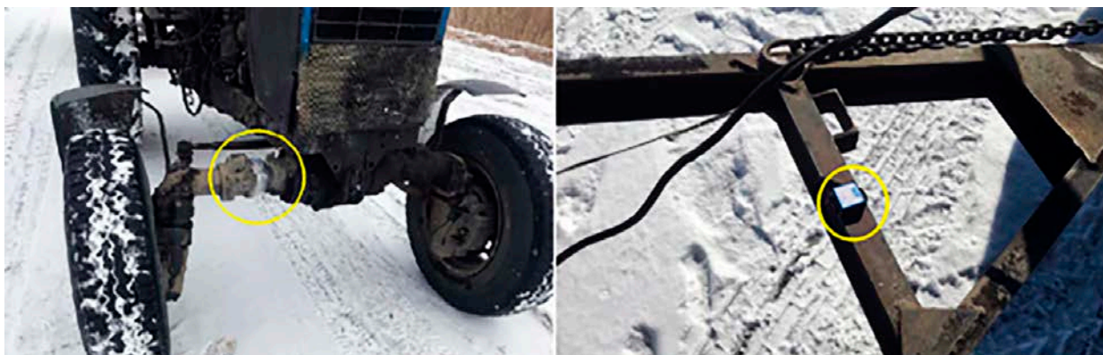
Рисунок 2 – Места установки инклинометрического датчика при исследованиях
