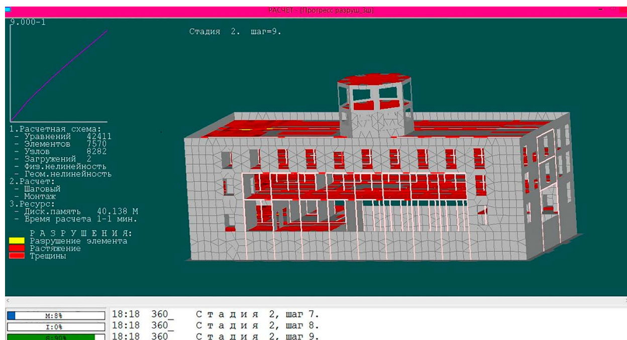
Рисунок 2 – Расчёт здания на прогрессирующее разрушение
