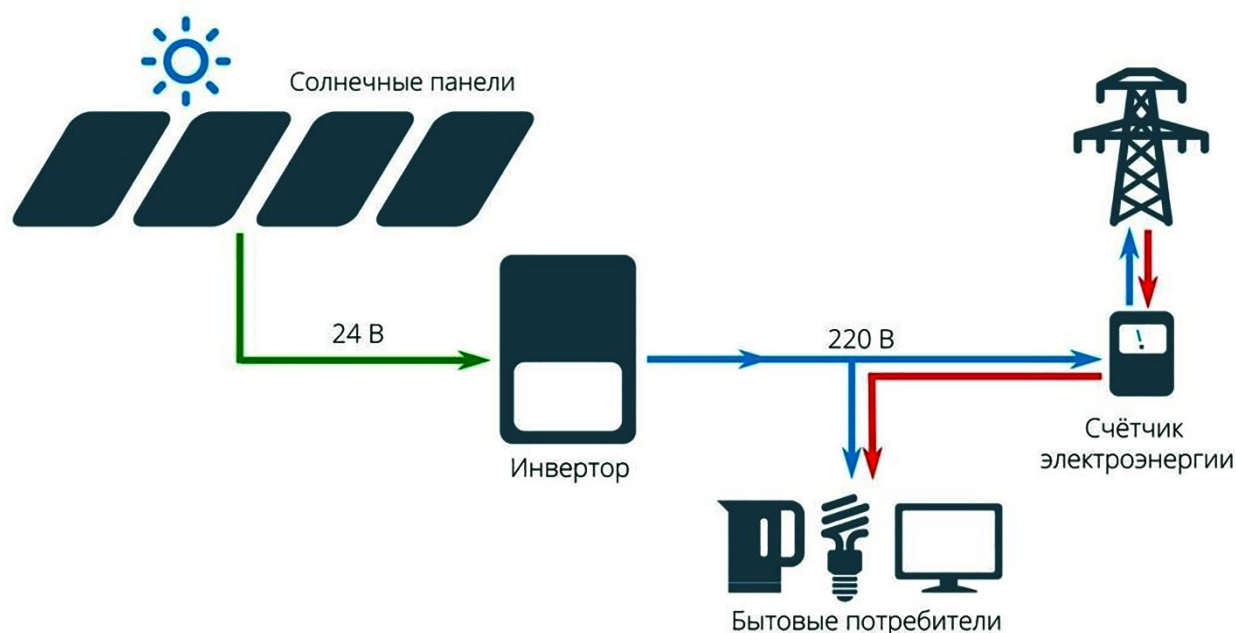
Рисунок 1 – Схема сетевой солнечной электростанции для частного дома с двунаправленным счетчиком
