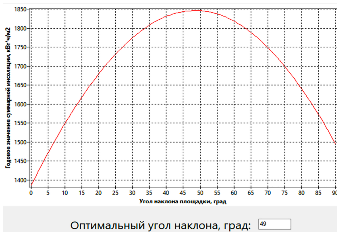
Рисунок 1 – Результаты расчета оптимального угла наклона для местности в районе Зейской ГЭС
