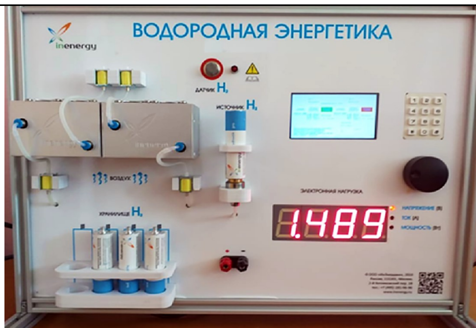
Рисунок 1 – Внешний вид стенда «Водородная энергетика» Energy при определении значения напряжения на первой батарее топливного элемента
