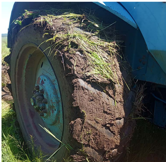
Рисунок 1 – Пример полного залипания протектора движителя трактора
