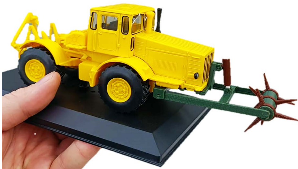
Рисунок 2 – Прототип прокалывателя-щелереза, изготовленного методом 3D-печати
