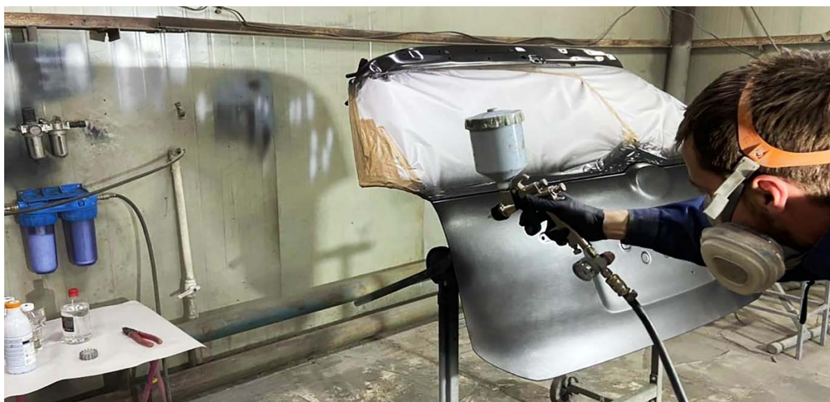
Рисунок 2 – Фрагмент технологического процесса нанесения лакокрасочного слоя на крышку багажника кузова автомобиля при помощи экспериментальной установки
