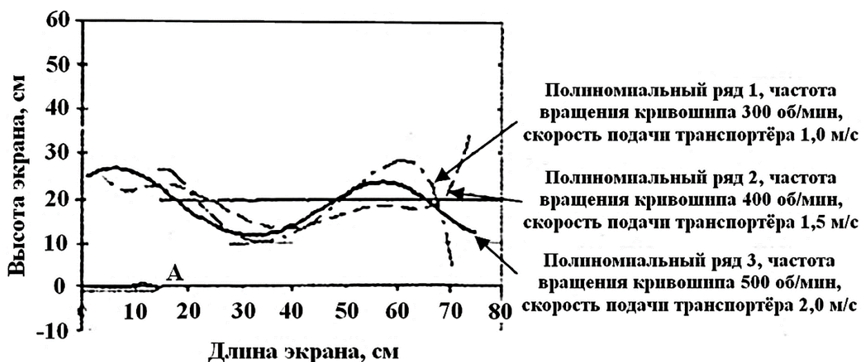
Рисунок 15.3 – Траектории движения центра масс стеблей при различной частоте вращения кривошипа и скорости подачи транспортера
