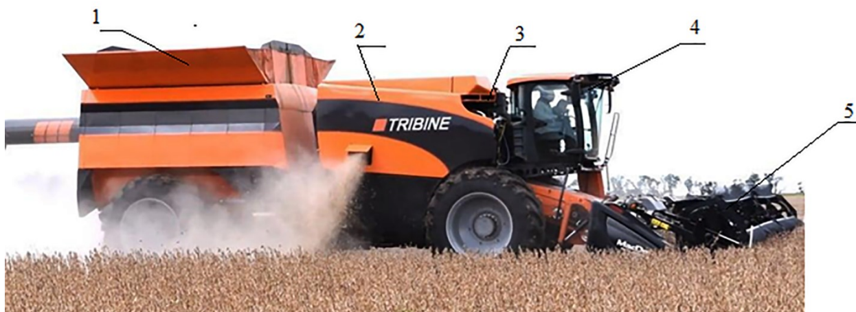
1 – бункер; 2 – очистка; 3 – двигатель (290 кВт); 4 – кабина; 5 – жатка
