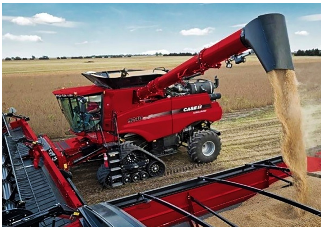
Рисунок 10.30 – Зерноуборочный комбайн «CASE IH» на полугусеничном ходу
