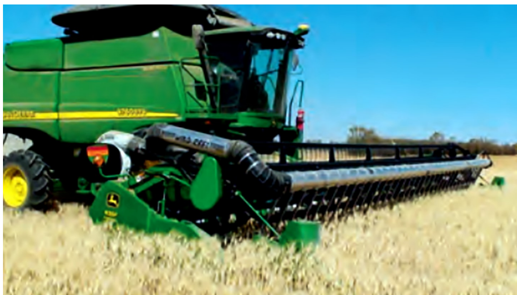
Рисунок 20.11 – Зерноуборочный комбайн с жаткой, оборудованной пневматическим мотовилом
