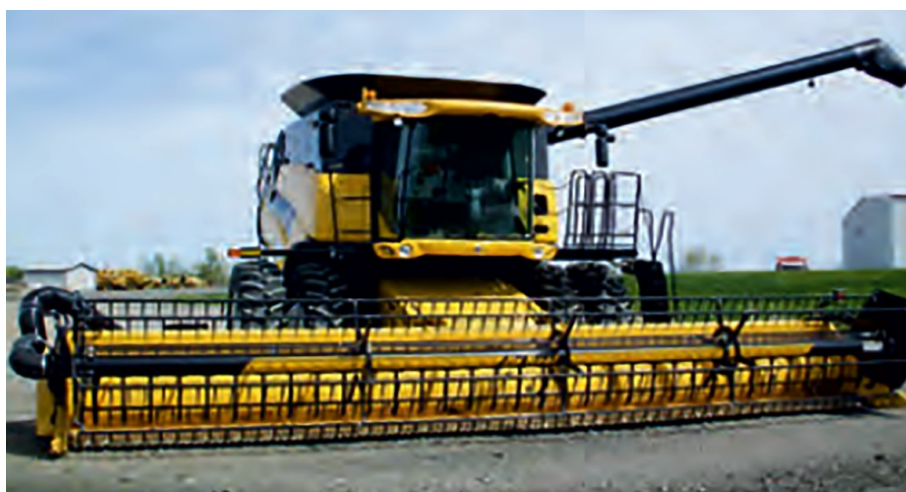
Рисунок 20.13 – Зерноуборочный комбайн с жаткой, оборудованной пневматическим мотовилом Craiy Air Reel
