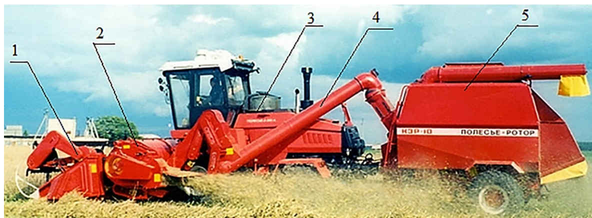
1 – жатка; 2 – роторное молотильно-сепарирующее устройство; 3 – универсальное энергетическое средство; 4 – шнековый транспортер вороха; 5 – прицепной очиститель-накопитель
