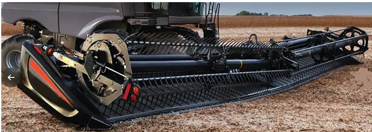
Рисунок 20.1 – Комбайн с складывающейся транспортной жаткой «Macdon» D1/FD1 (ширина захвата – 7,6; 13,7 м)
