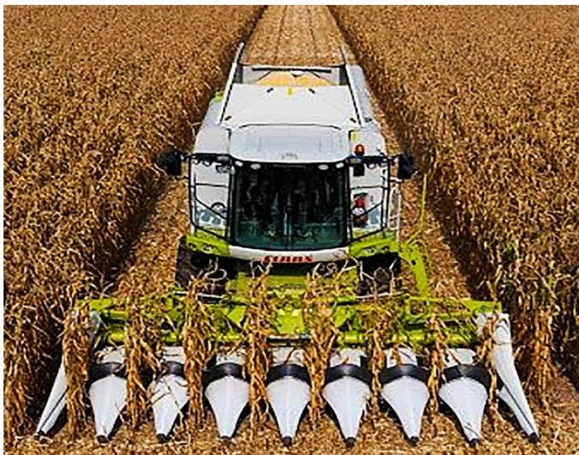
Рисунок 10.29 – Жатка для уборки кукурузы CORIO в работе
