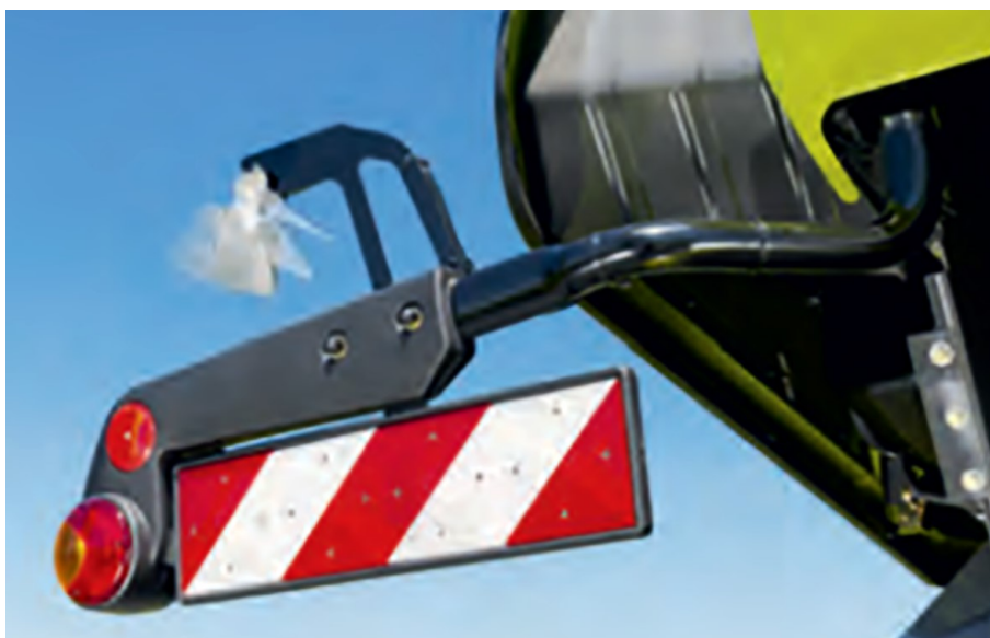
Рисунок 20.19 – Датчики ветра и уклона на зерноуборочном комбайне
