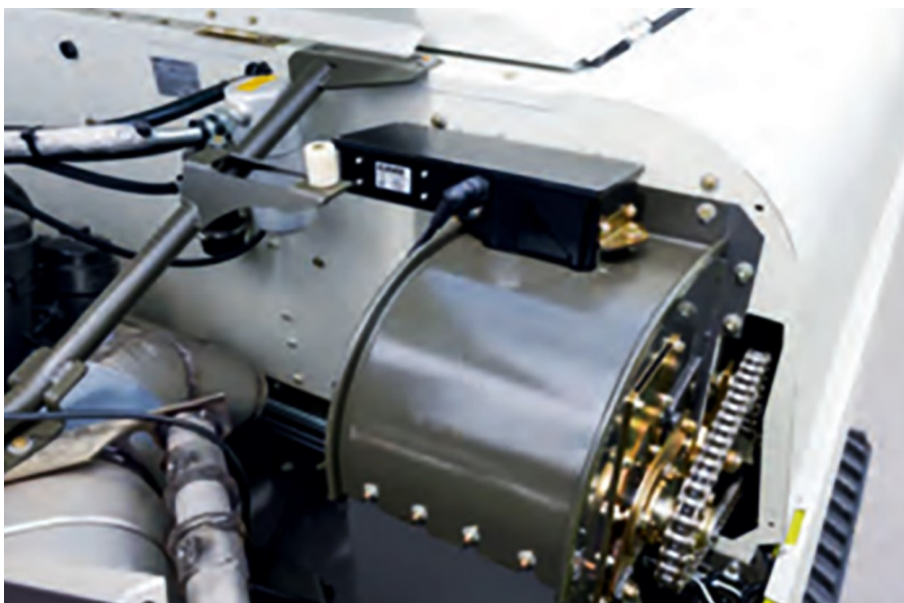
Рисунок 20.18 – Расположение фотокамеры на зерновом элеваторе
