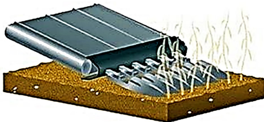
Рисунок 20.2 – Схема размещения транспортера и режущего аппарата
