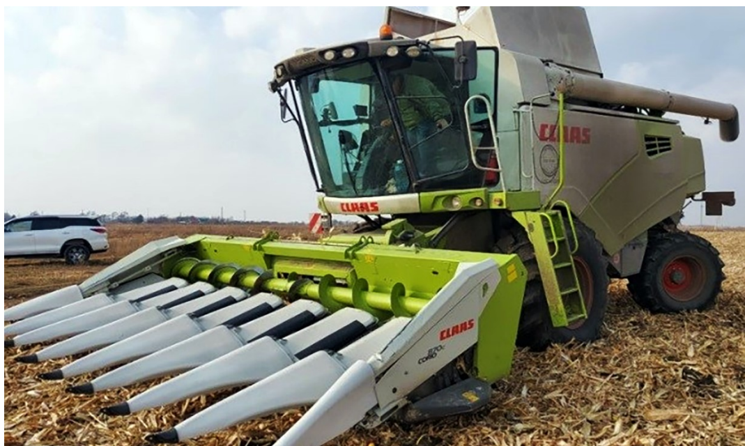
Рисунок 20.5 – Зерноуборочный комбайн Claas с восьмирядковой жаткой на уборке кукурузы
