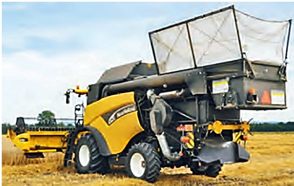
Рисунок 20.14 – Зерноуборочный комбайн с бункером для сбора половы
