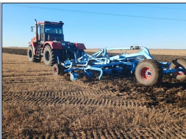
Рисунок 2 – Почвообрабатывающий агрегат К744Р4+ Lemken kristall 9/600
