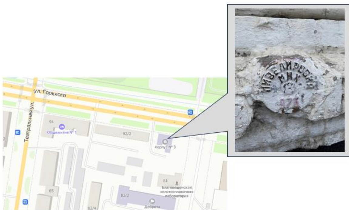
Рисунок – Пункт полигонометрии
