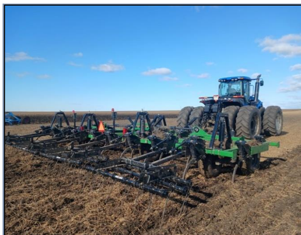
Рисунок 1 – Почвообрабатывающий агрегат New Holland+ культиватор Summers
