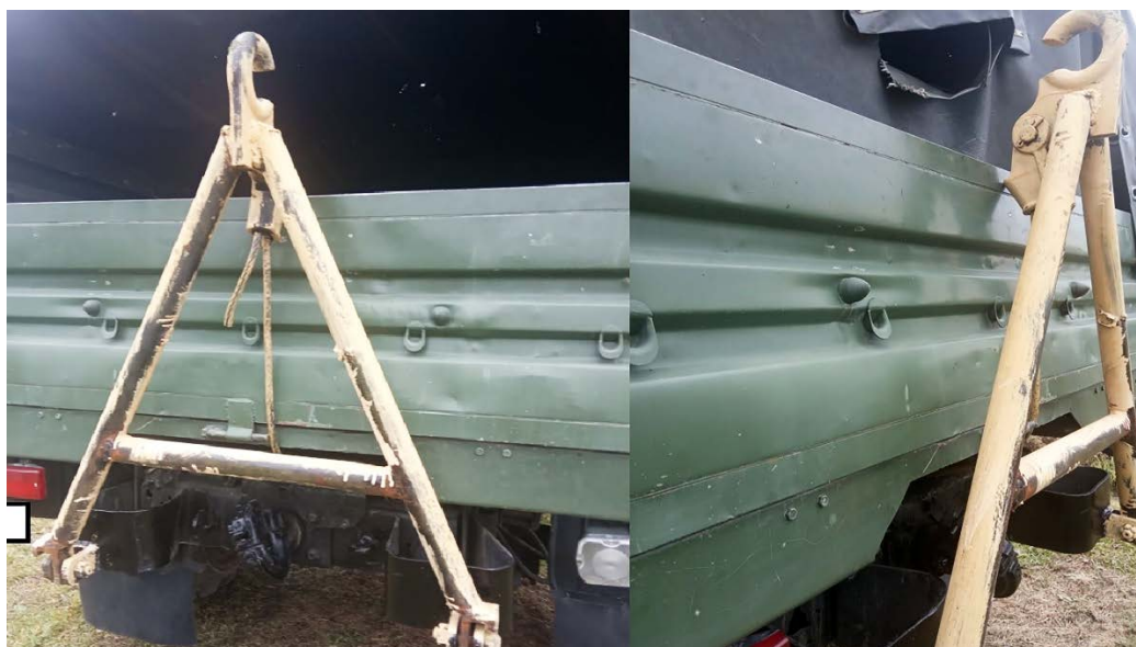
Рисунок 3.8 – Чалочный крюк догружающего модуля для грузового автомобиля (транспортное положение)
