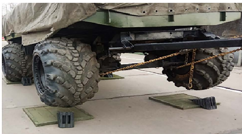
Рисунок 3.10 – Цепная силовая связь для регулирования и фиксации дышла прицепа в транспортном положении
