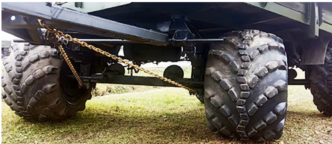
Рисунок 3.10 – Цепная силовая связь для регулирования и фиксации дышла прицепа в транспортном положении
