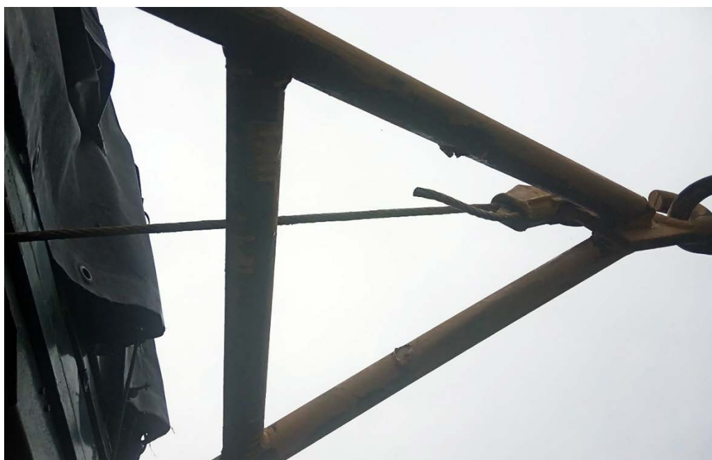
Рисунок 3.7 – Чалочный крюк с гибкой лебедочной тросовой частью догружающего модуля для грузового автомобиля
