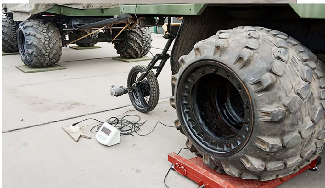
Рисунок 3.11 – Фрагмент исследований по поднятию переднего моста прицепа при работе устройства
