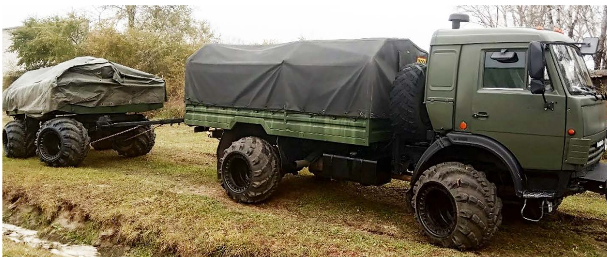
Рисунок 3.3 – Автомобиль КамАЗ-4350 с догружающим модулем для грузового автомобиля и прицеп ПН-4М на арочных шинах
