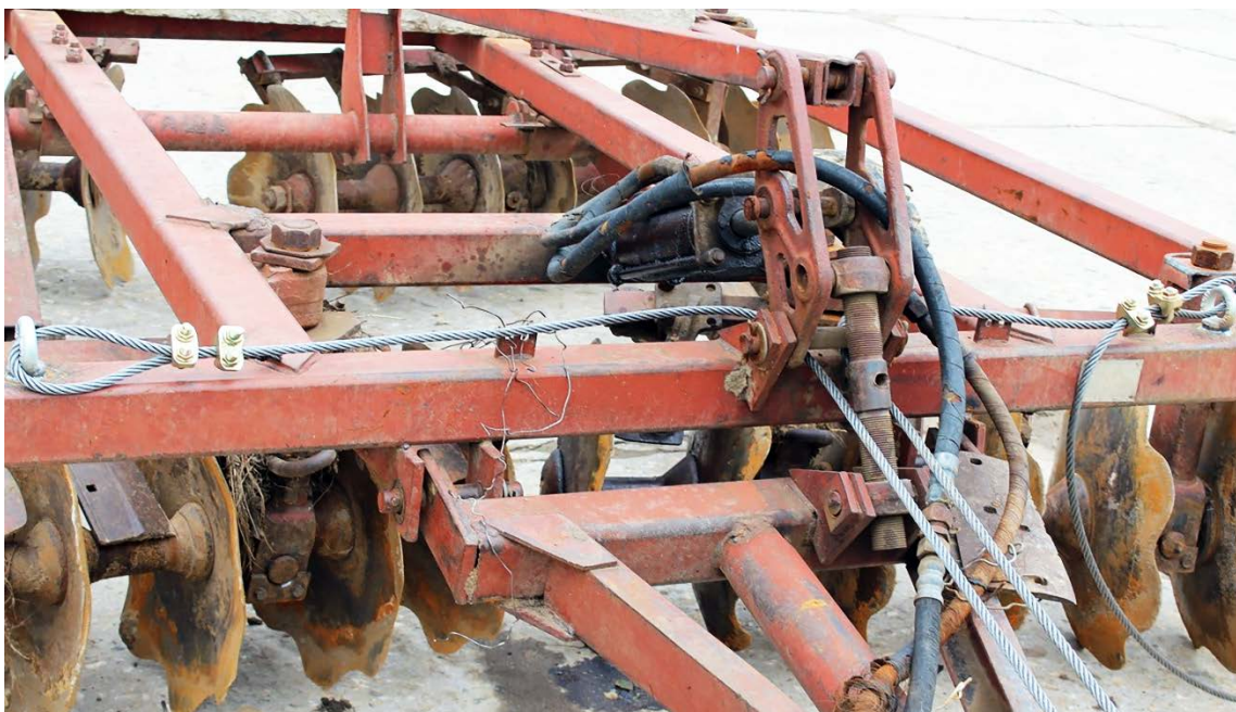
Рисунок 3.7 – Установочные кронштейны на фронтальной части рамы
