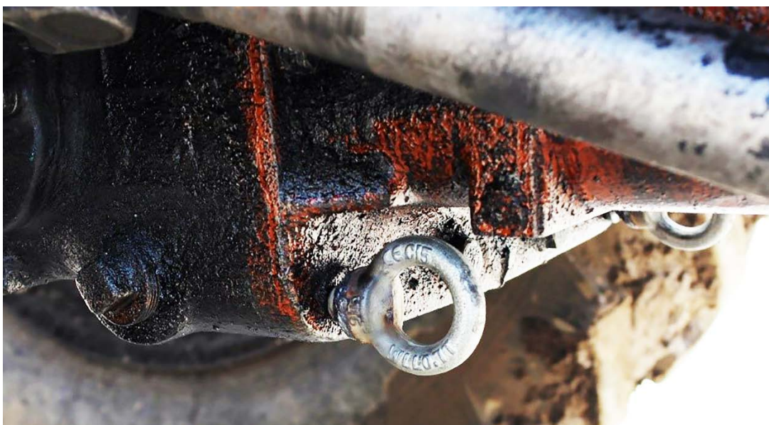
Рисунок 3.5 – Кронштейн на нижней тыльной части корпуса КПП
