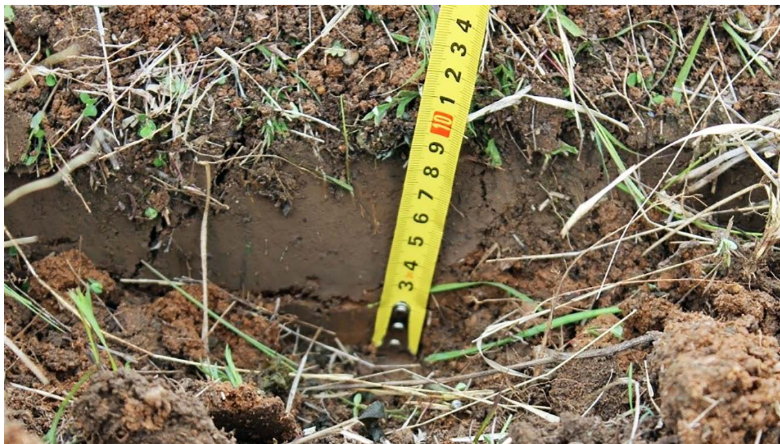
Рисунок 3.44 – Измерение глубины обработки почвы после прохода серийной бороны БДТ-3
