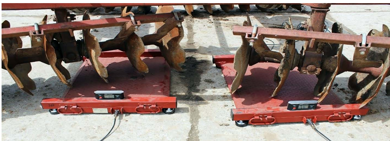
Рисунок 3.37 – Проведение измерений нагрузки, приходящейся на рабочий орган бороны
