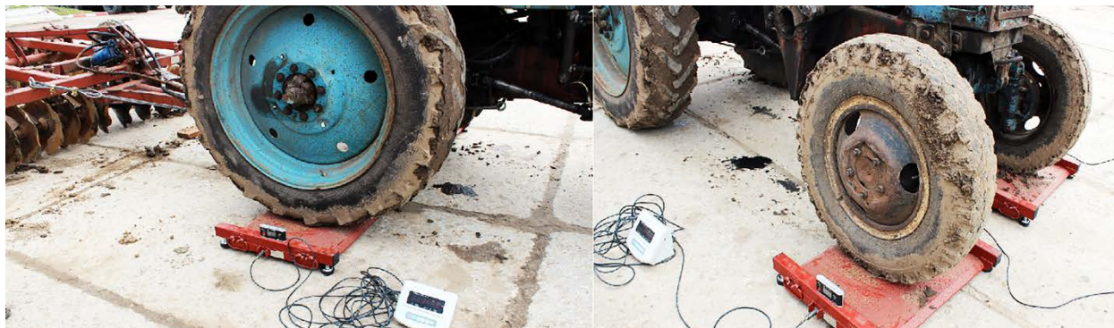
Рисунок 3.40 – Проведение испытаний по перераспределению нагрузки
