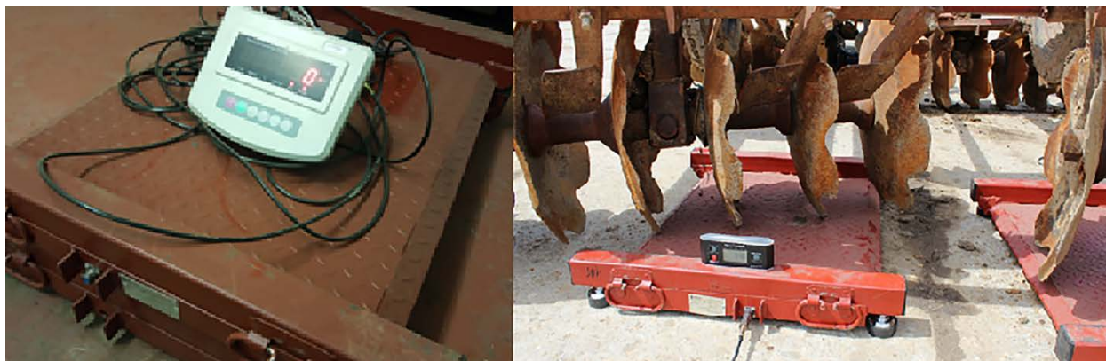
Рисунок 3.8 – Фрагмент измерения веса, приходящегося на рабочий орган бороны
