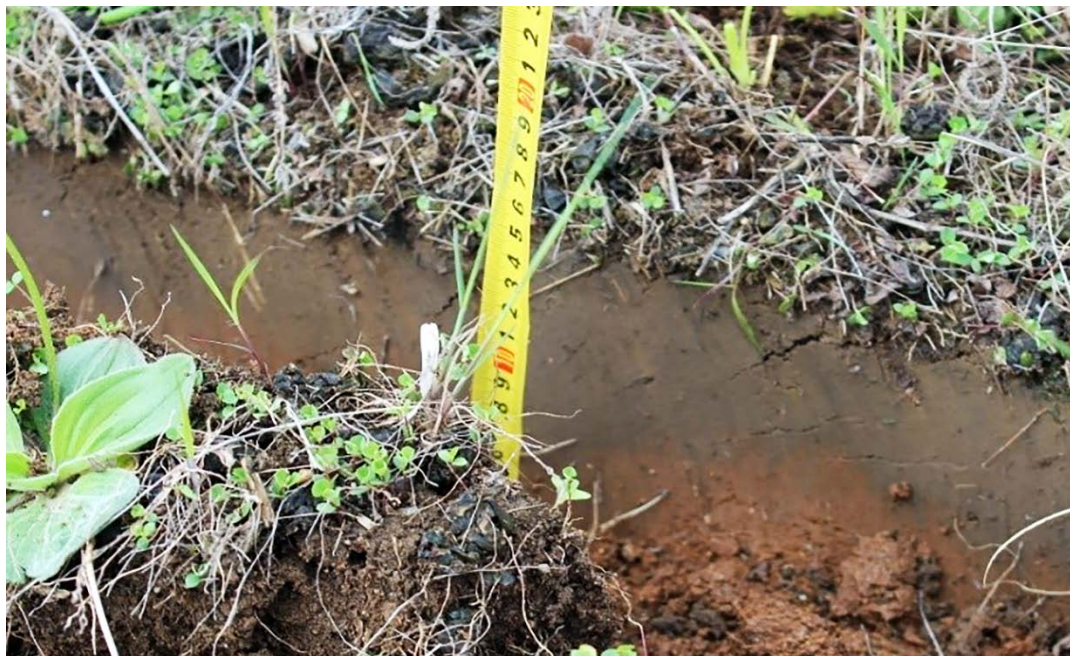
Рисунок 3.45 – Измерение глубины обработки почвы после прохода экспериментальной бороны БДТ-3
