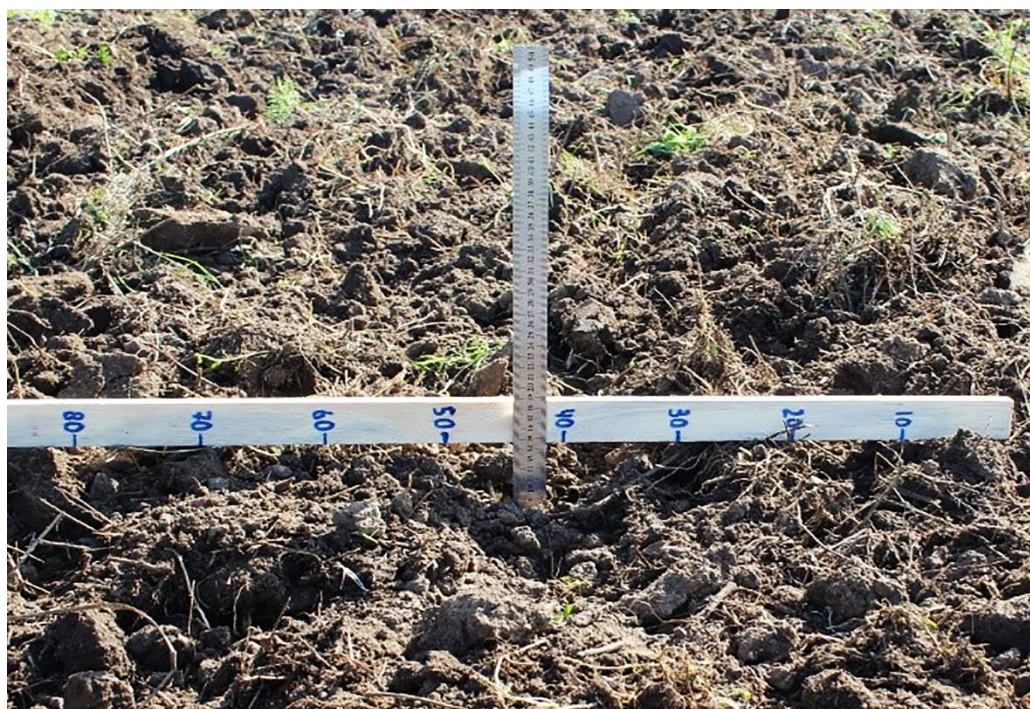
Рисунок 3.10 – Измерение глубины обработки экспериментальным МТА
