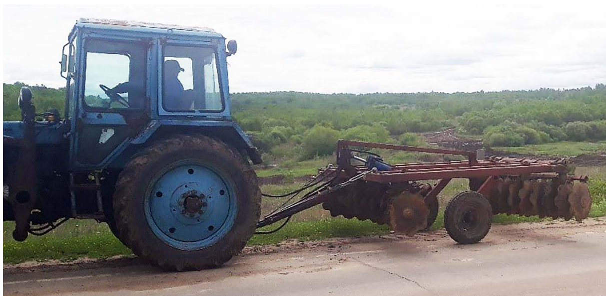
Рисунок 3.12 – Трактор МТЗ-80 с экспериментальной бороной в транспортном положении
