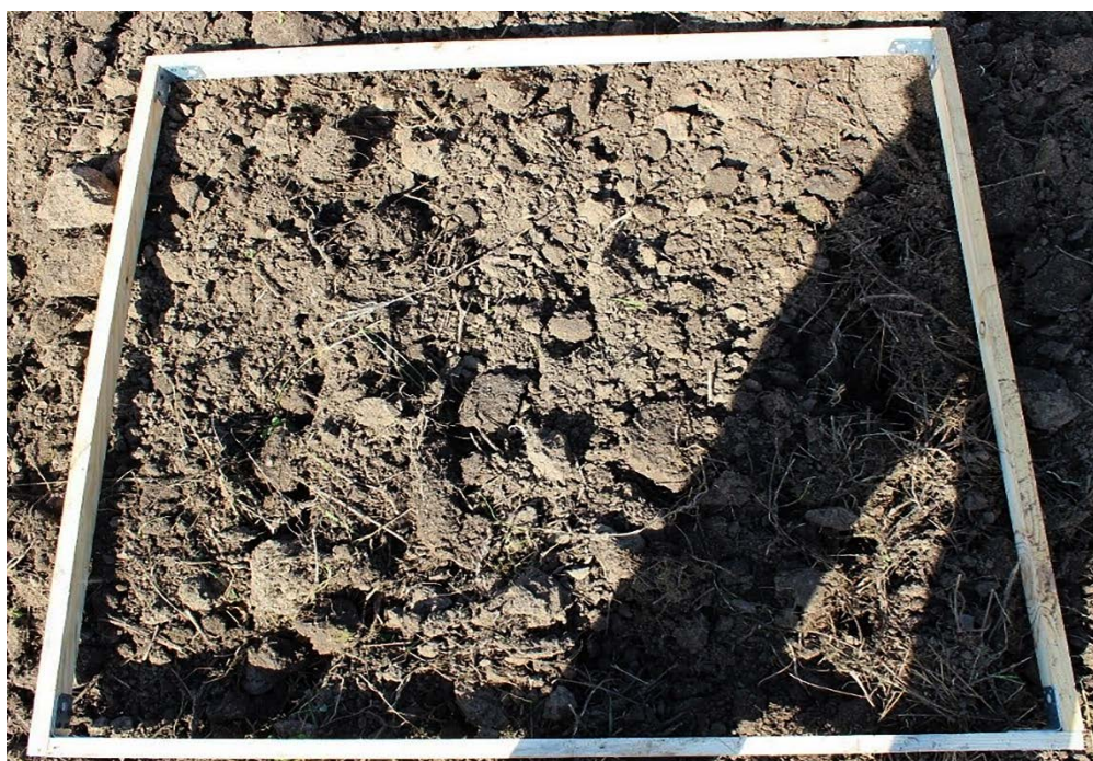
Рисунок 3.11 – Определение комковатости почвы после прохода экспериментального МТА
