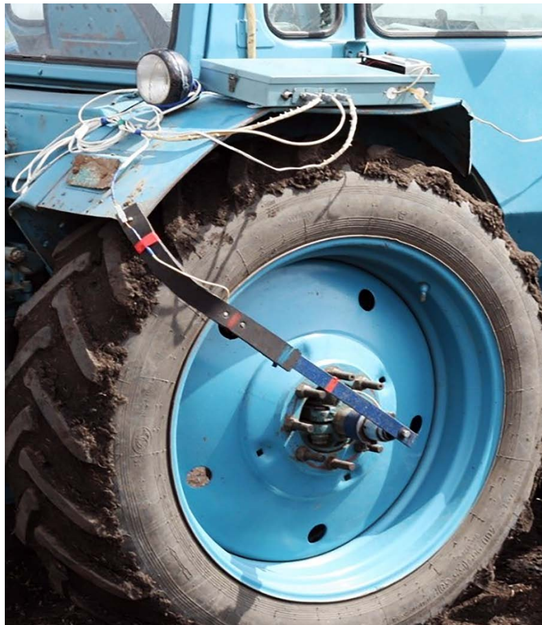
Рисунок 3.8 – Измерение частоты вращения ведущих колес
