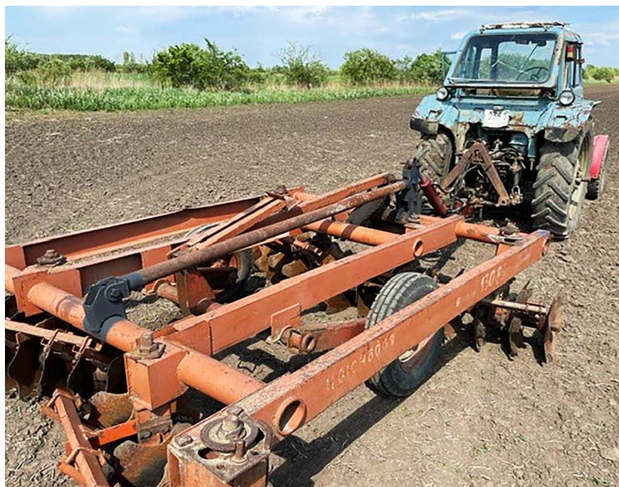
Рисунок 2 – Общий вид машинно-тракторного агрегата с установленным устройством для перераспределения нагрузки
