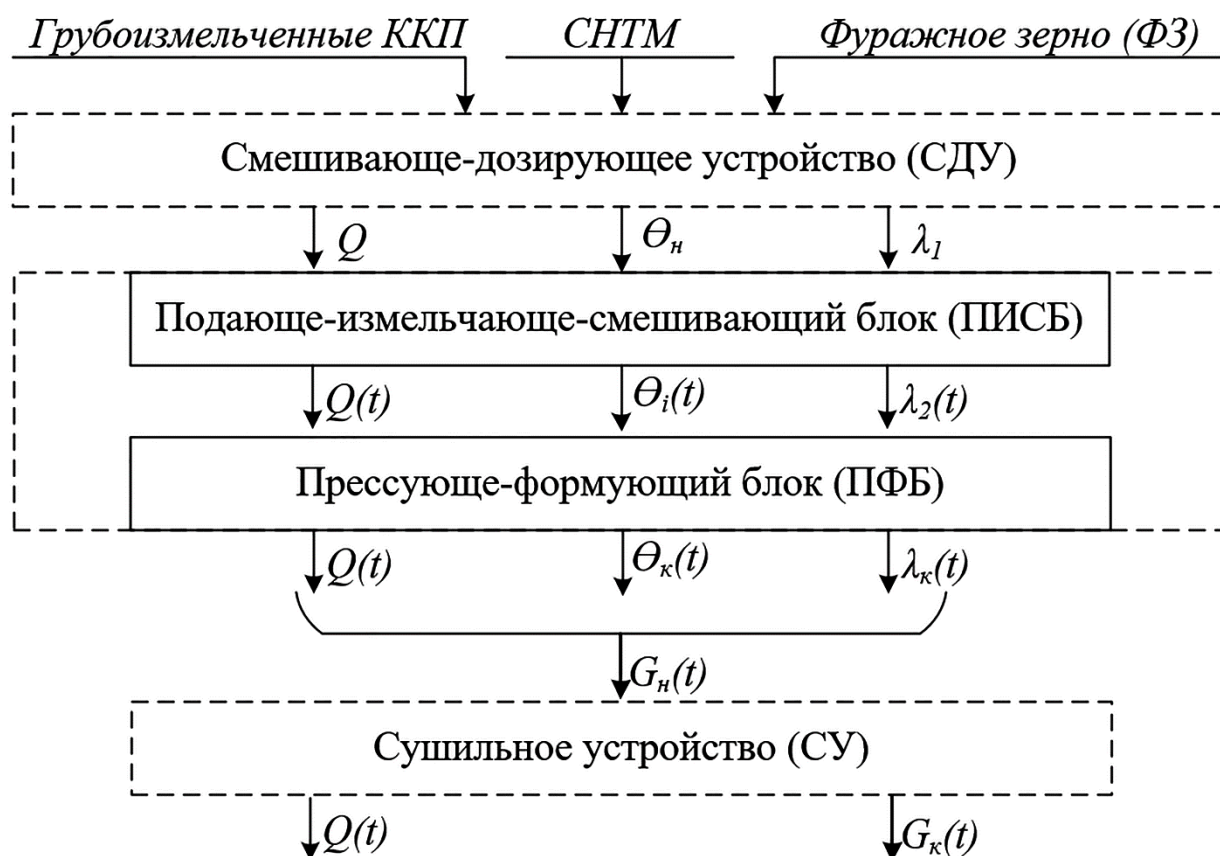
Рисунок 1 – Формализованная структурно-функциональная схема устройства для производства формовано-прессованных изделий
