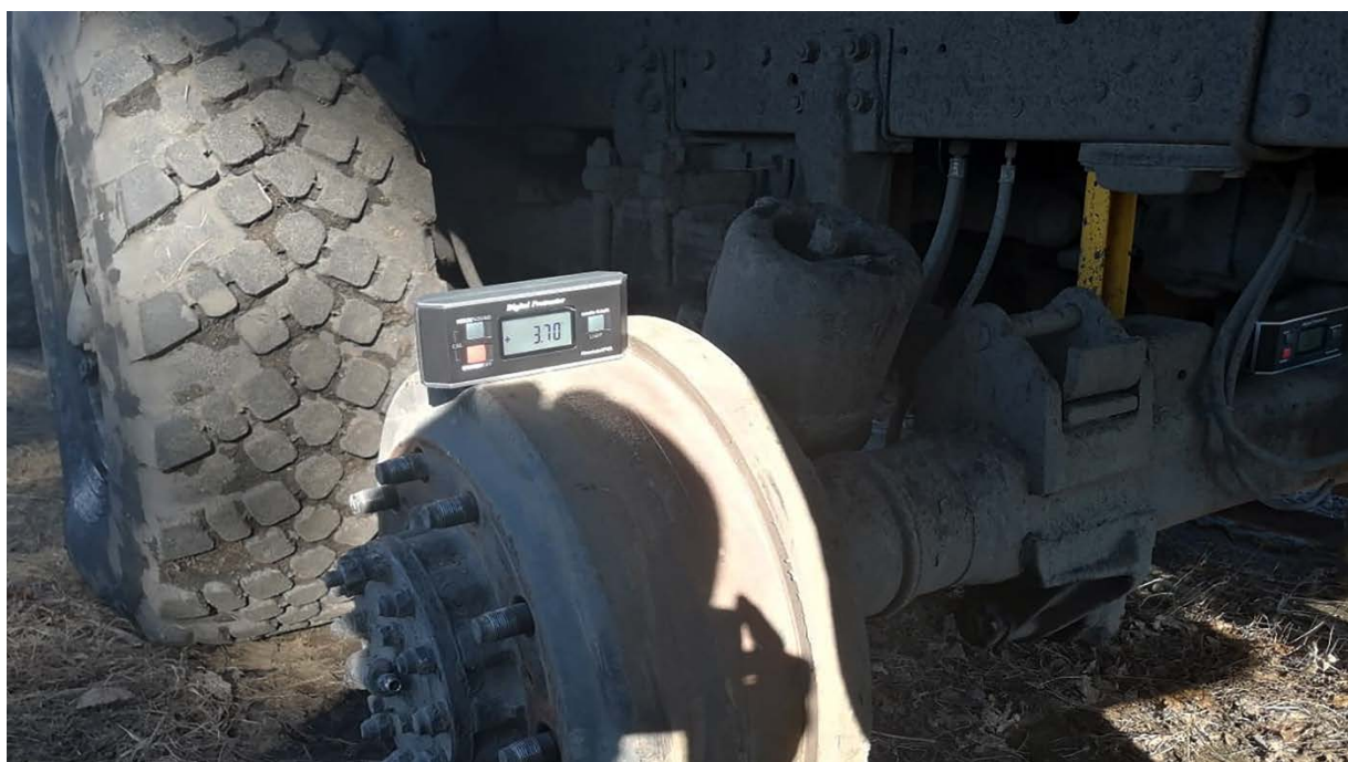
Рисунок 3.11 – Измерение угла наклона моста транспортного средства при работе устройства
