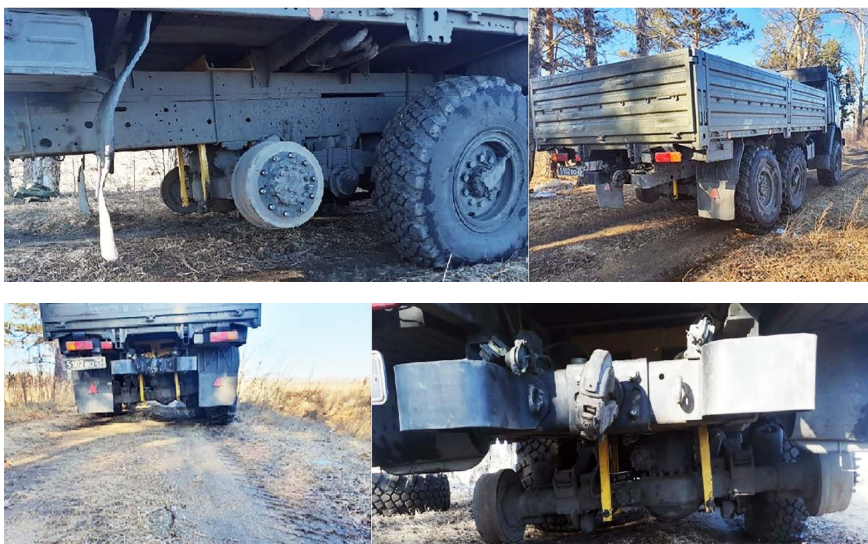
Рисунок 3.35 – Фрагмент проведения экспериментальных исследований по проверке работоспособности регулятора нагрузки (профильный и фронтальный вид)
