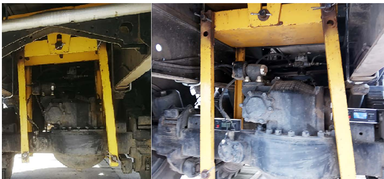
Рисунок 3.3 – Устройство для межколесного перераспределения веса – рамочный регулятор нагрузки
