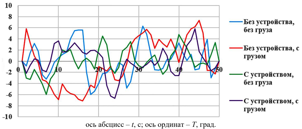
Рисунок 3.21 – Экспериментальные показатели отклонения узла «тягово-сцепное устройство трактора – дышло прицепа» по оси Z в режиме установившегося движения при передвижении по грунтовой дороге
