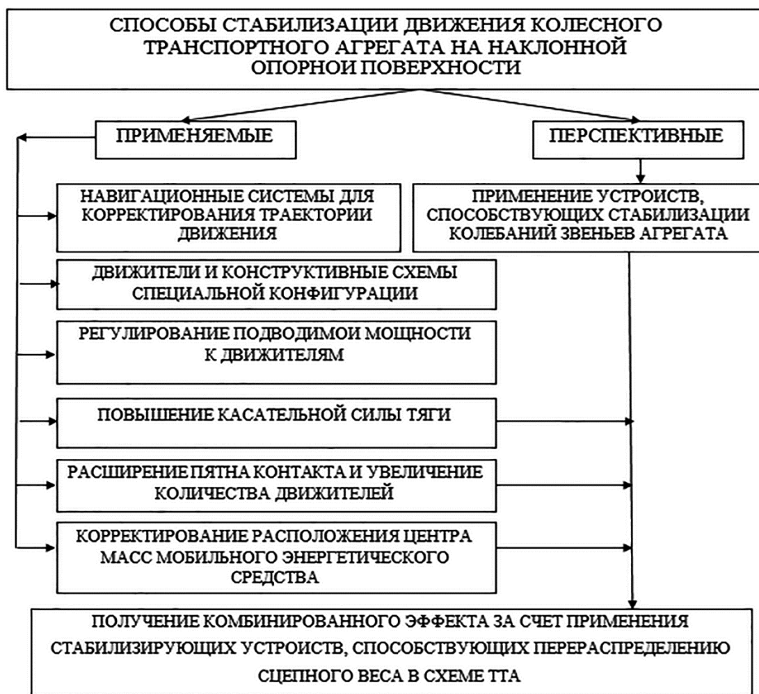
Рисунок 1.16 – Способы стабилизации звеньев ТТА
