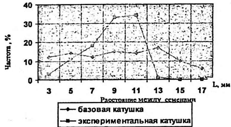
Рис. 41. Распределение семян сои вдоль ряда методом непосредственного нахождения в почве при рядовом посеве
