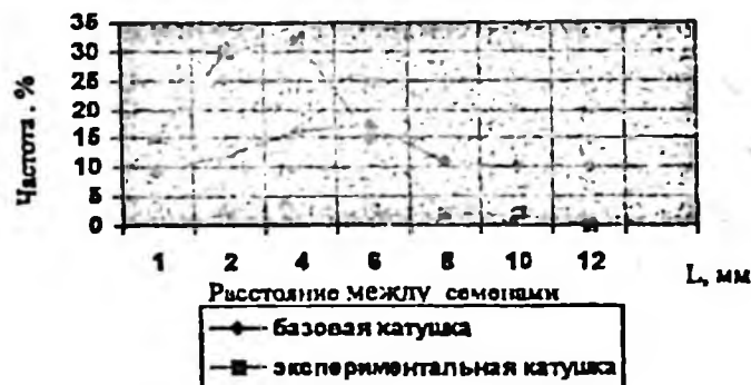
Рис. 43. Распределение семян сои вдоль ряда при широкорядном способе посева
