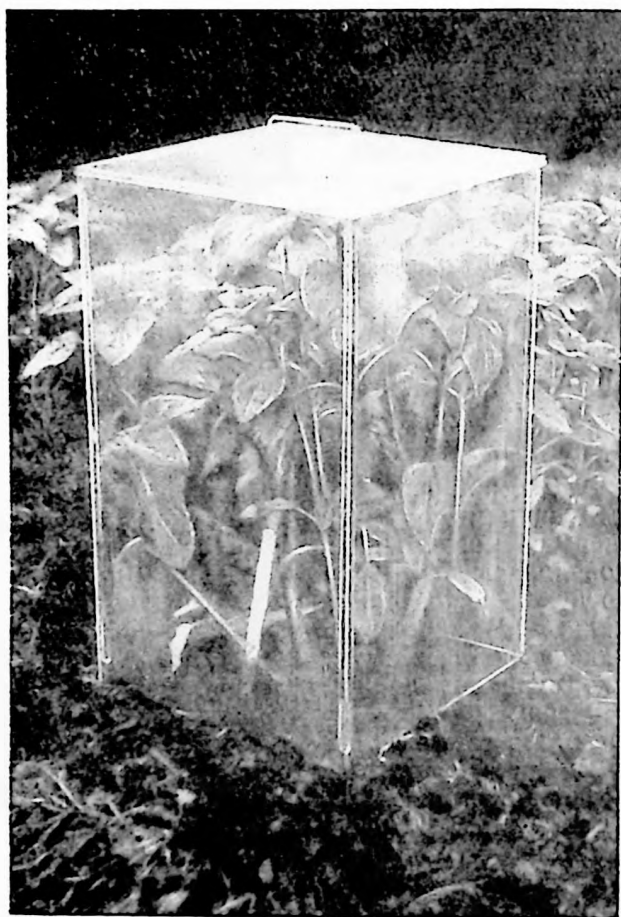
Рис. 1. Камера для питания растений радиоактивным углеродом ( C^{14} )
