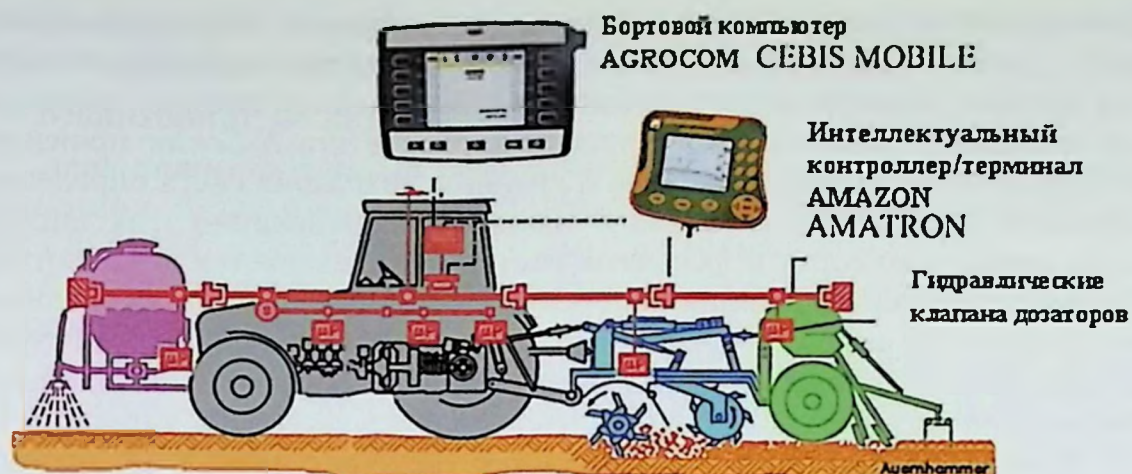
Рисунок 182. Дифференцированное внесение удобрений
