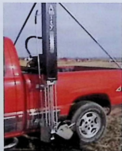
Рисунок 181. Отбор почвенных образцов
