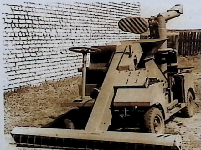
Рисунок 105. Лазерная установка «Львов-1 Электроника» ЛГН-104 на протравливателе семян ПС-10
