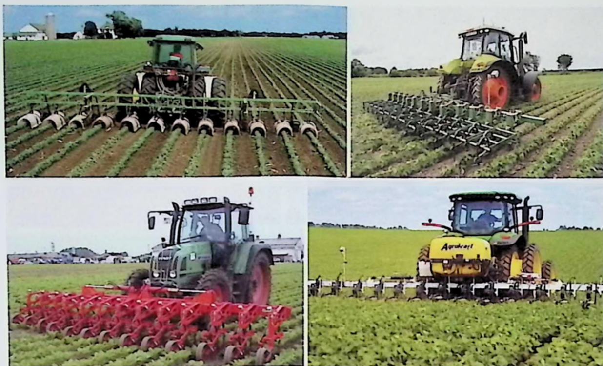
Рисунок 212. Междурядная культивация и подкормка сои в разные фазы развития
