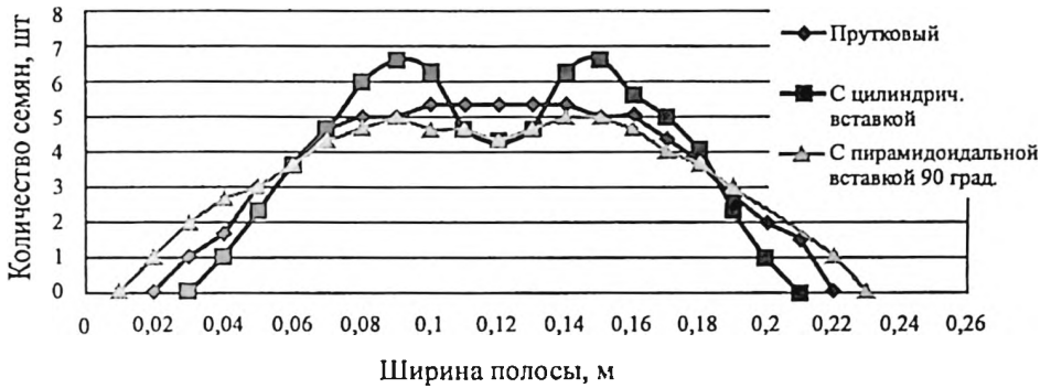
Рис. 3.27. Зависимости равномерности распределения семян по ширине засеваемой полосы от конструктивных параметров распределителей семян
