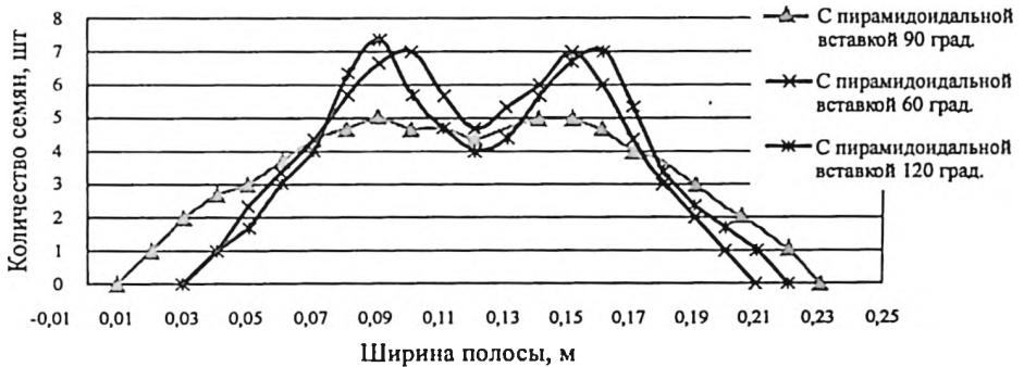
Рис. 3.28. Зависимости распределения семян по ширине засеваемой полосы, пластинчатым распределителем от угла при вершине пирамидоидального элемента
