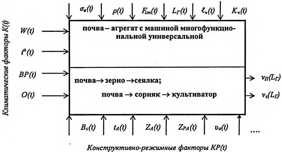
Рис. 2.13. Формализованная модель взаимодействия элементов системы почва → агрегат с машиной многофункциональной универсальной
