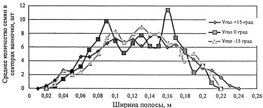
Рис. 3.31. Зависимости влияния угла наклона семяпровода на равномерность распределения семян по ширине полосы
