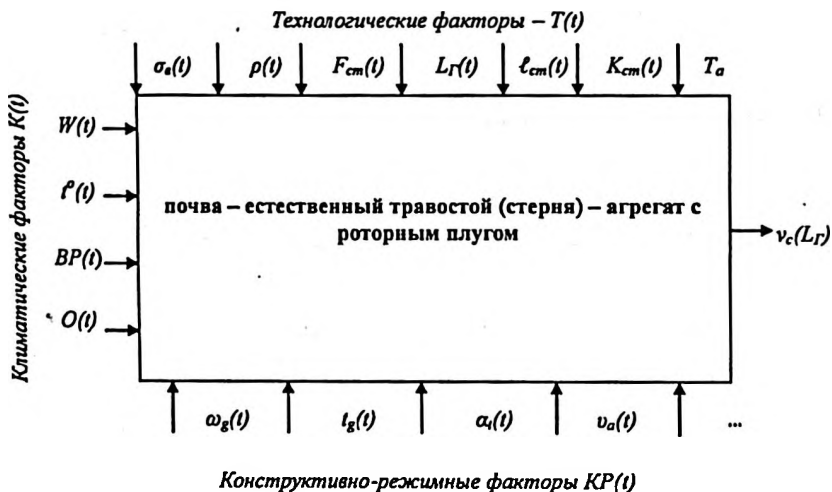
Рис. 2.6. Формализованная модель взаимодействия элементов системы почва→естественный травостой (стерня)→агрегат с роторным плугом
