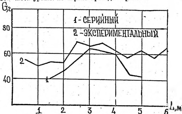
Рис. 2. Рабочая ширина и равномерность разбрасывания массы измельчающим барабаном ПУН-5.
