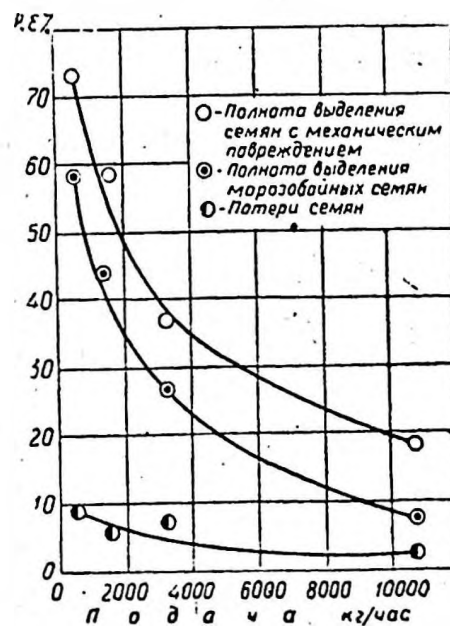
Рис. 2. Влияние подачи на качество очистки семян сои вертикальным воздушным потоком.
