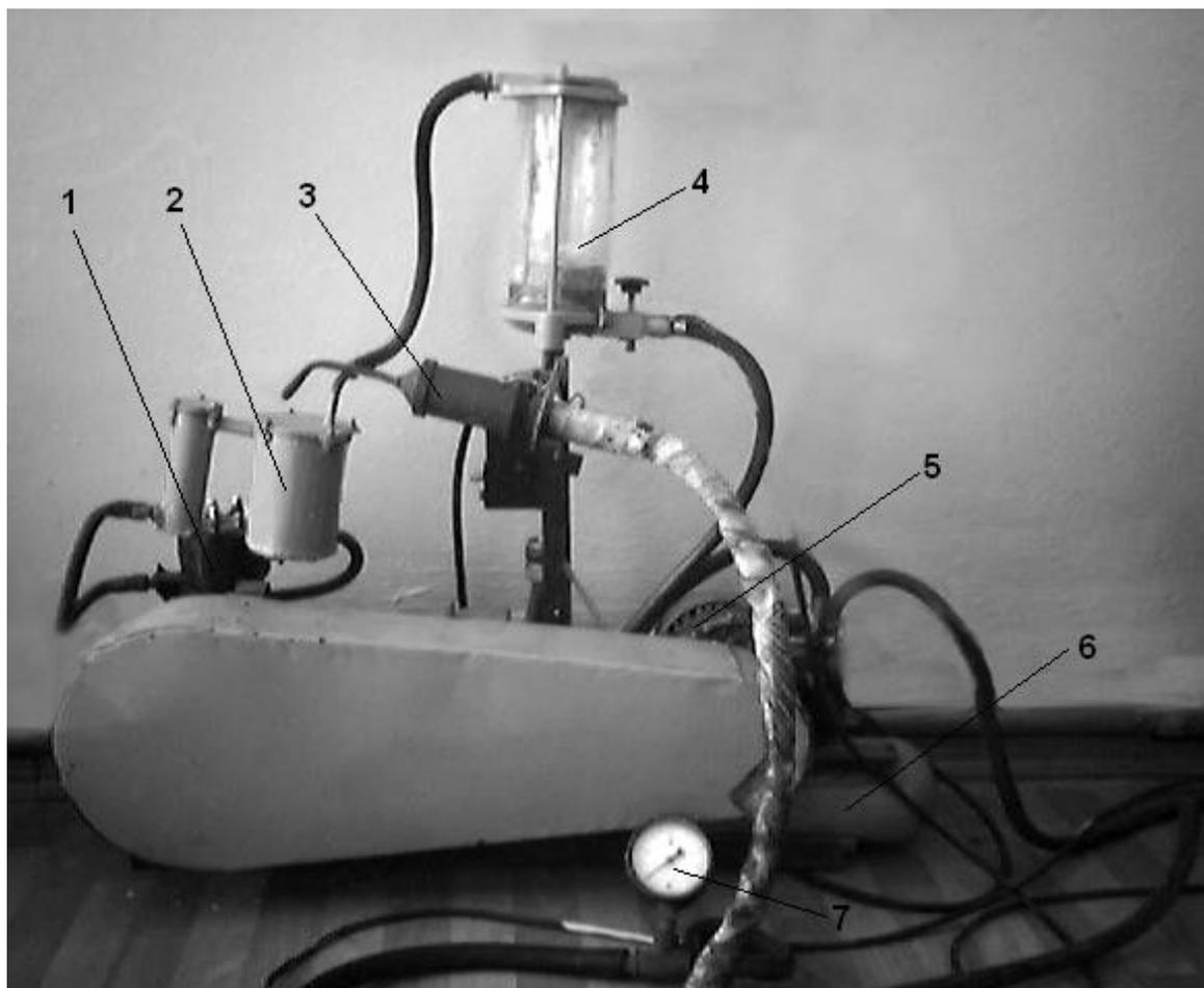
Рисунок 3.3 – Схема установки для сварки и наплавки пластмасс
