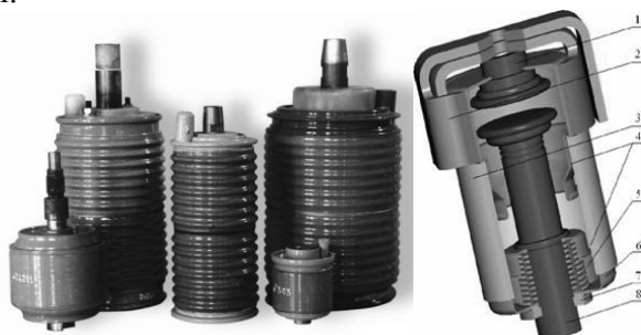
Рис. 5.5. Дугогасительная камера вакуумного выключателя: а – внешний вид; б – разрез; 1- неподвижный контакт; 2- внешний виток; 3-керамический цилиндр; 4-экран (коммутационная камера); 5-металлический сильфон; 6- фланец; 7-направляющая подвижного контакта; 8-подвижный контакт
