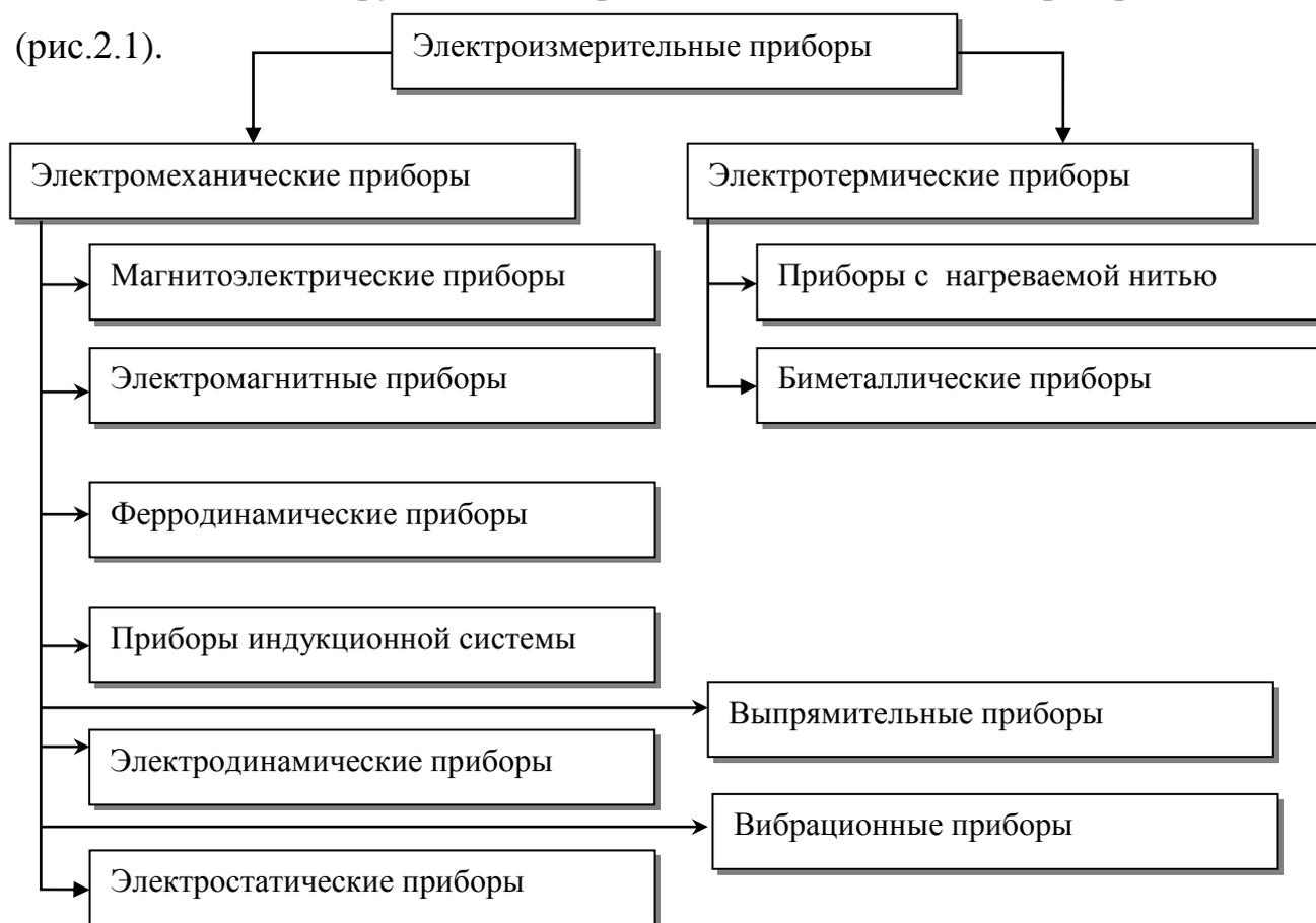
Рисунок 2.1 – Классификация аналоговых измерительных приборов
