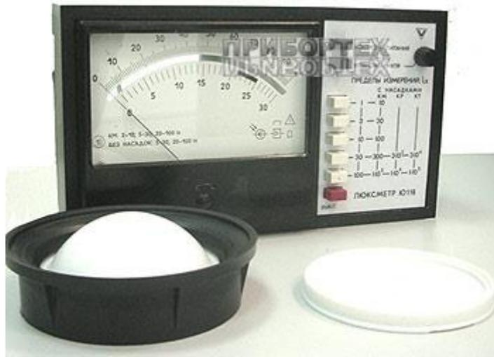
Рис. 1.4. Общий вид люксметра Ю-117
