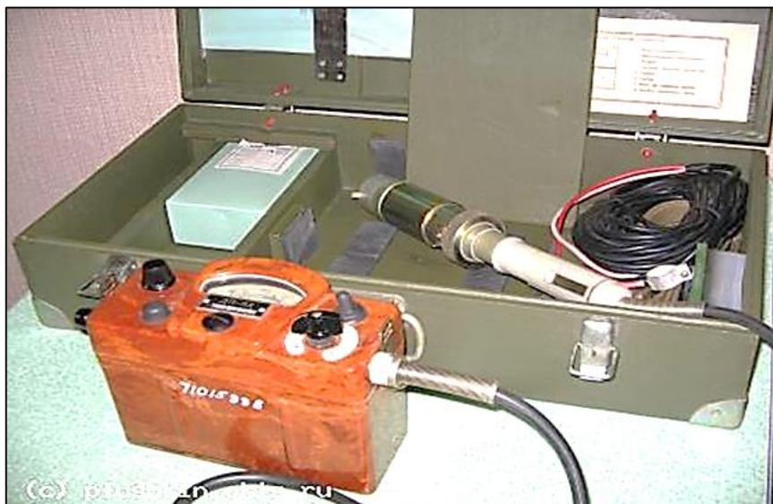
Рисунок 11. Полевой дозиметр типа ДП-5А
