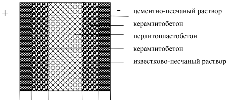
Рис.4.3.1. Трехслойная керамзитобетонная панель
