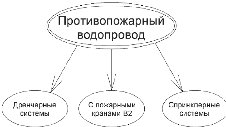
Рис. 1.20. Классификация противопожарных водопроводов
