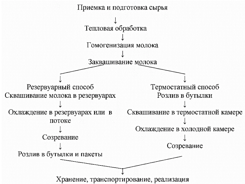
Рис.2. Технологическая схема производства кисломолочных напитков резервуарным и термостатным способами
