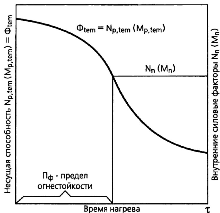
Рисунок 2.3 – Общая схема расчета предела огнестойкости конструкции по потере ее несущей способности
