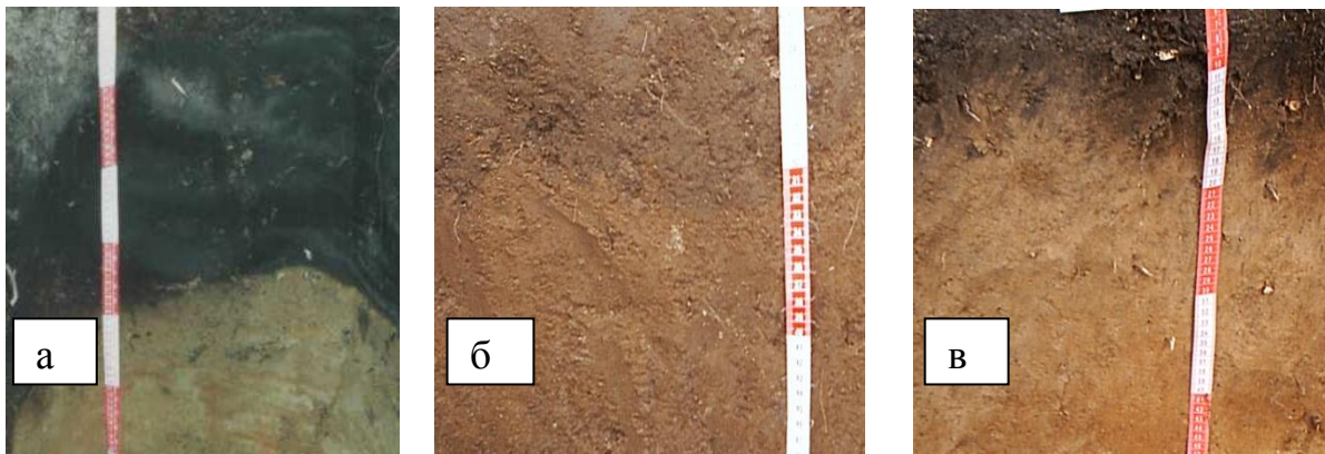
Рисунок 3 – Виды перехода горизонтов: а – резкий, б – ясный, в - постепенный.
