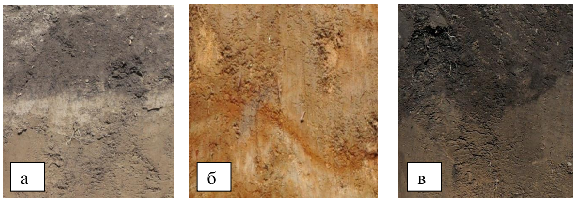
Рисунок 3 – Виды перехода горизонтов: а – резкий, б – ясный, в - постепенный.
