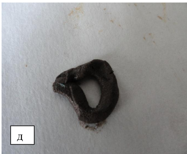
Рисунок 6 – Гранулометрический состав: а – песок; б – супесь; в – легкий суглинок; г – средний суглинок; д – тяжелый суглинок; е – глина.
